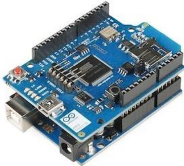
*Figura 4.2 Arduino UNO con tarjeta Logger Shield [22]*
