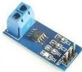
*Figura 4.6 Sensor de corriente modelo ACS 712 [22]*
