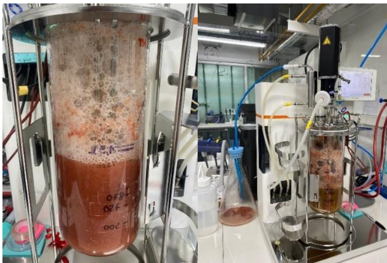
Figura 4. Problema operacional asociado a la espuma en la fermentación 1.
