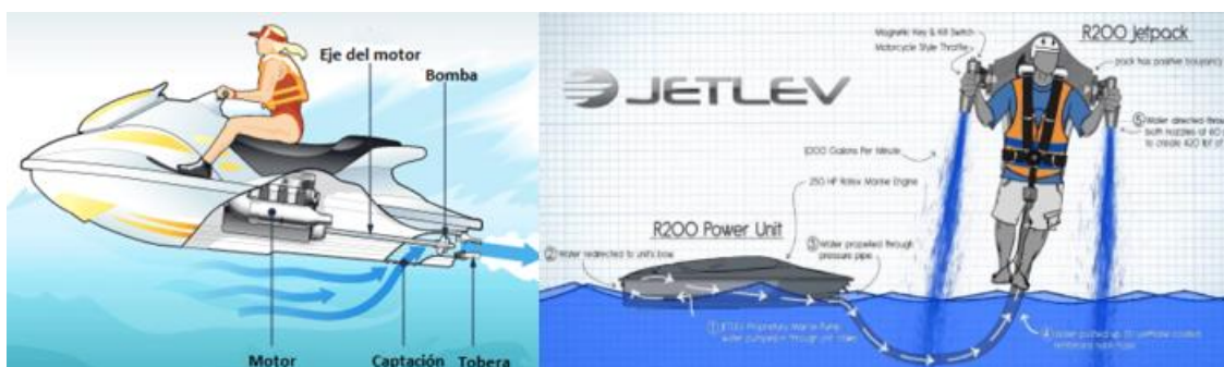
Figura 6: Alcance de la propulsión waterjet más allá de su uso en embarcaciones.
