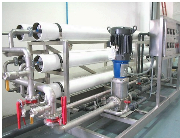
Figura 9: 6 tubos de alta presión ensamblados en estructura de acero. (Fuente: www.awasa.com.mex )
