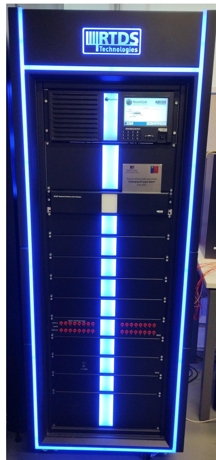
FIGURA 1.1: Rack de hardware NovaCore 2.0 de RTDS, obtenido por FONDEQUIP EQM 210117
