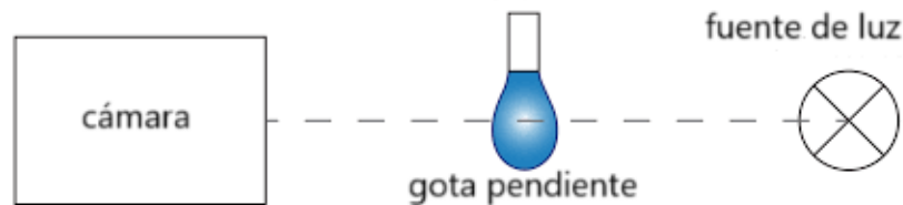
Figura 2.1: Esquematzación del método de gota pendiente. Tomado de [12]
