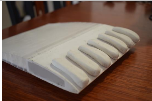
Figura 10.4: Prototipo con modificación de Siete Tubérculos Largos (7TL)
