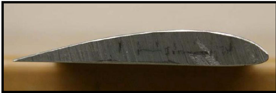
Figura 1.2: Vista lateral del perfil alar Clark Y-14
