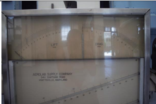
Fig. 7.3: Tablero superior, fuerzas Lift y Drag
