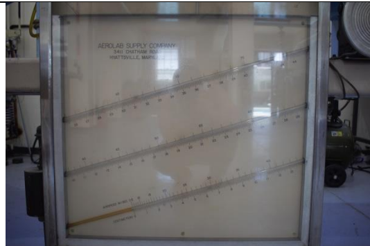
Fig. 7.4: Tablero inferior, Velocidad en m/s
