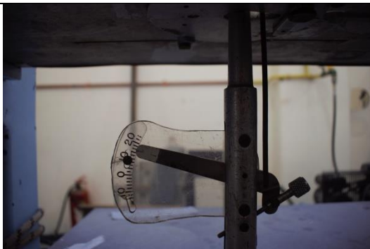
Fig. 7.16: eje con variador de ángulo de ataque
