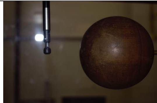
Fig. 7.15: anemómetro midiendo antes de la esfera
