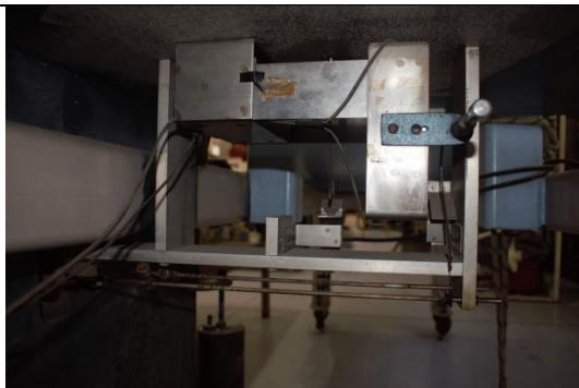
Fig. 7.5: Mecanismo de transmisión de fuerzas
