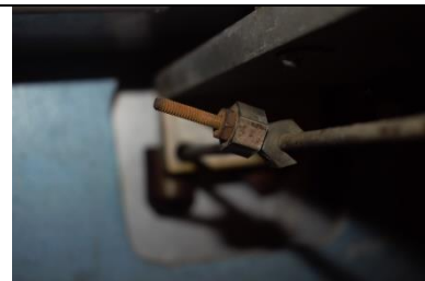
Fig. 7.13: Tuerca de ajuste preciso situada cerca del eje
