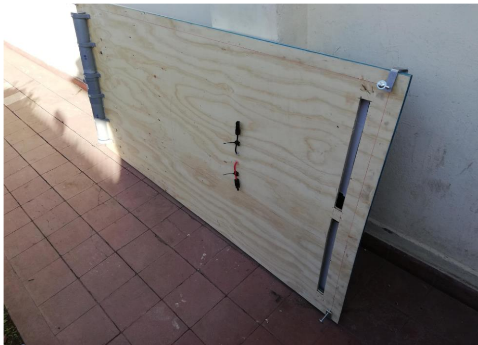
Figura 34: Radiador de aire de módulo fotovoltaico de 320W.
