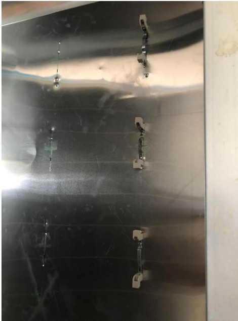
Figura 56: Imagen de soquetes instalados en la puerta del simulador.
