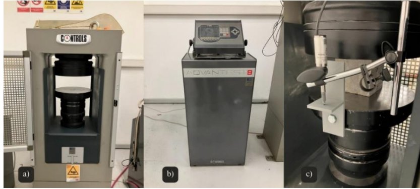
Figura 14: Configuración de equipos utilizada para el ensayo de compresión uniaxial, en donde: a) Prensa, b) Sistema servo-hidráulico y c) sensor LVDT.
