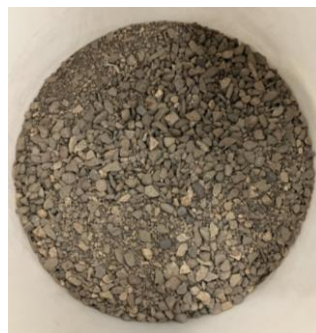
Figura 8: Granulometría y características de áridos marca Áridos Figueroa.
