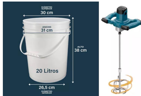
Figura 11: Esquema del equipo de mezcla para preparación de muestras de hormigón.
