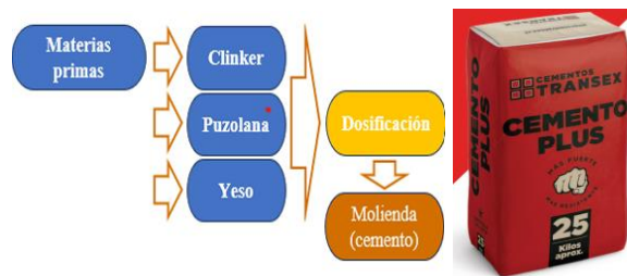
Figura 7: Composición y proceso de fabricación del cemento Transex Plus.
