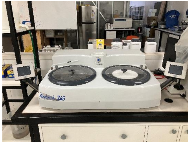
Figura 13: Pulidora circular Minitex 265 utilizada para acondicionar muestras.
