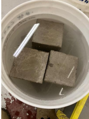
Figura 12: Proceso de curado por inmersión en agua saturada de cal (Norma ASTM C192).
