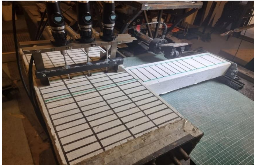
Figura 25 Probeta instalada en mesa sísmica
