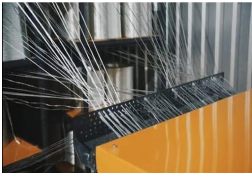
Figura 2 Método de entrelazado de hebras para la fabricación de barras FRP (Fuente: Composite Tech , 2023)
