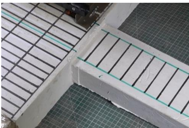
Figura 19 Probeta pintada y con la armadura marcada
