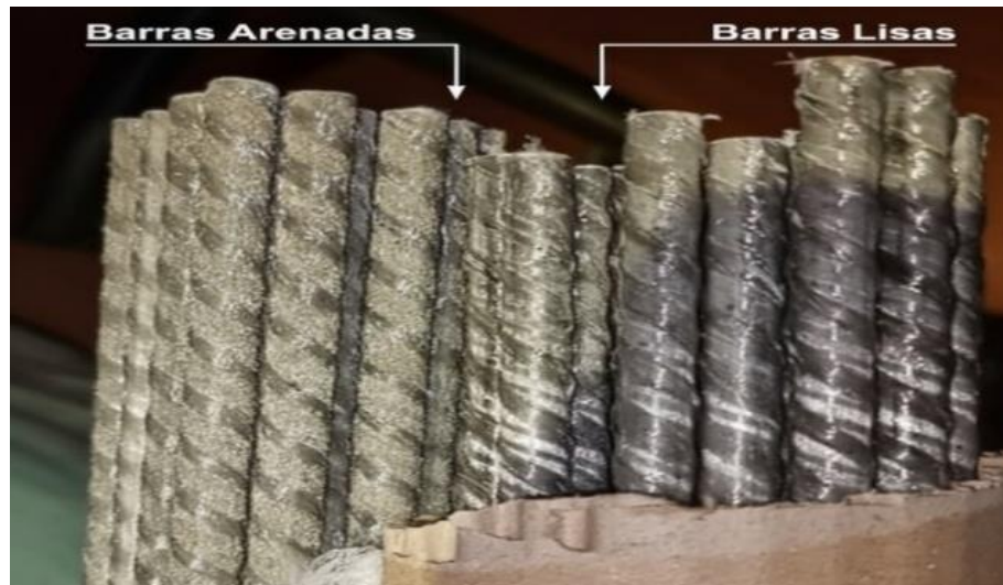
Figura 3 barras con recubrimiento de arena junto a barras sin recubrimiento
