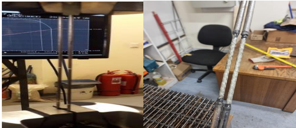
Figura 11 preparación de barras para el ensayo a tracción
