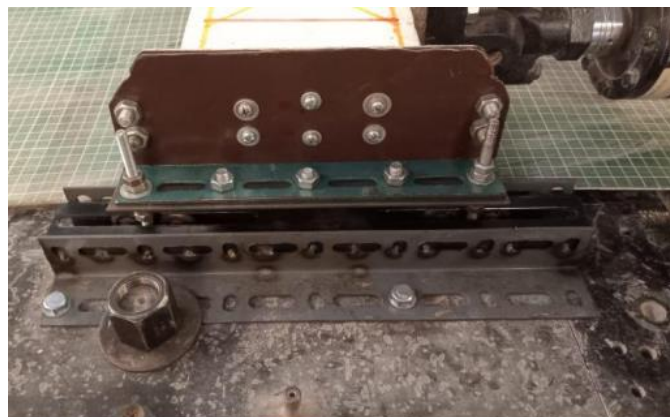
Figura 24 Riel de soporte de viga
