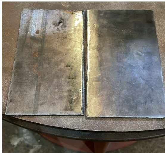
Figura 6.17: Planchas de limpias
