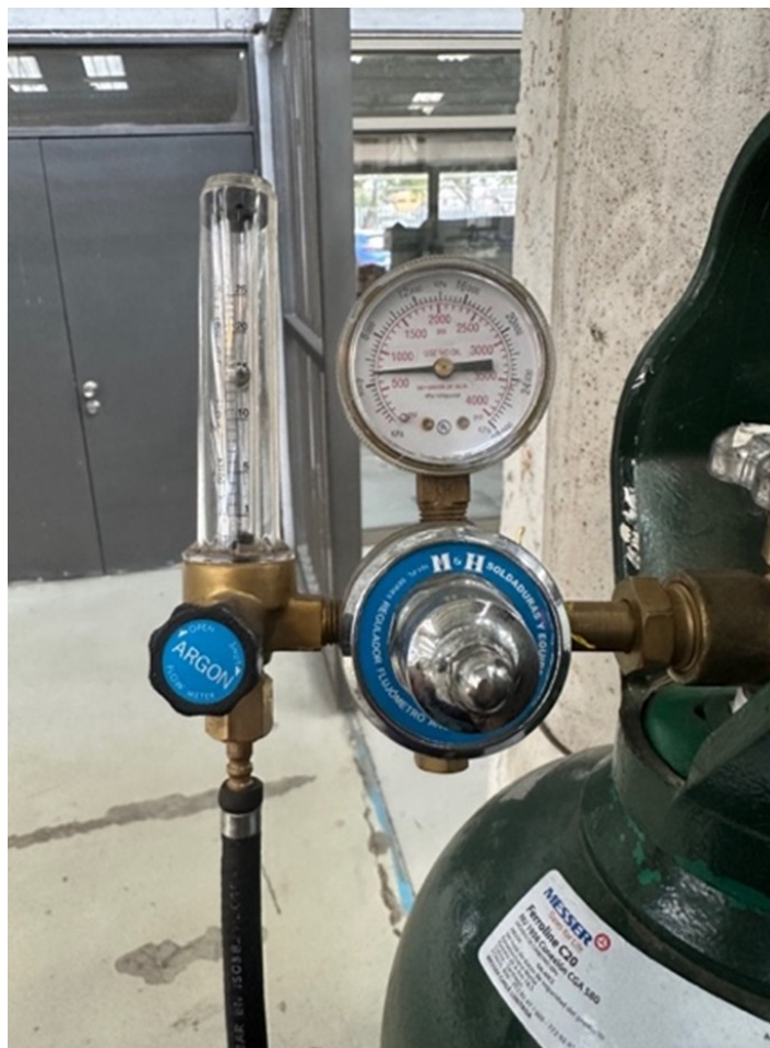
Figura 2.8: Manómetro para argón con flujómetro incorporado
