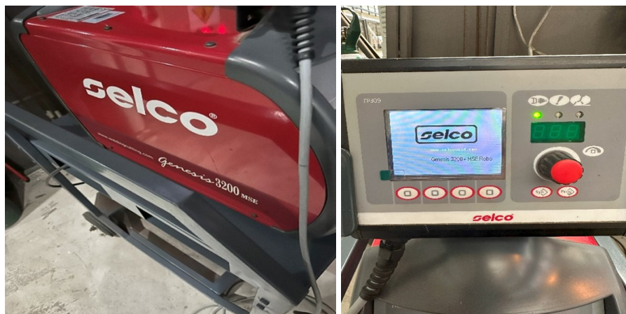
Figura 2.5: Máquina soldadora Selco genesis 3200
