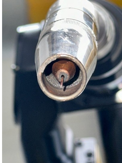
Figura 5.8: Antorcha soldadora vista desde abajo
