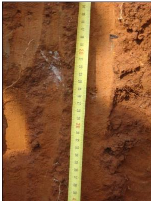
Figura 5.1: Excavación de calicata
