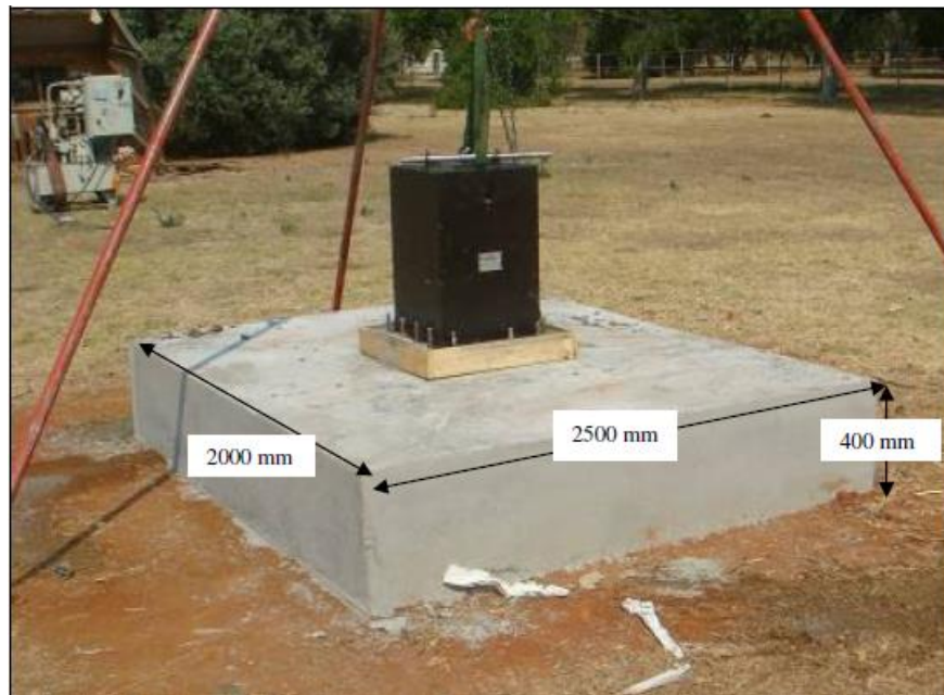
Figura 5.6: Fundación superficial utilizada en el experimento
