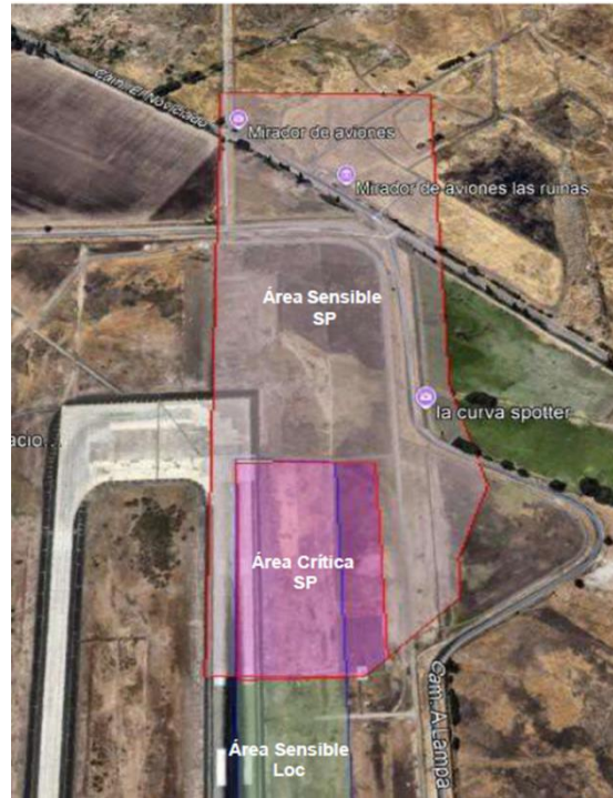
Ilustración 3-2: Representación de las áreas protegidas del Localizador y Senda de Planeo de la pista 17L.
