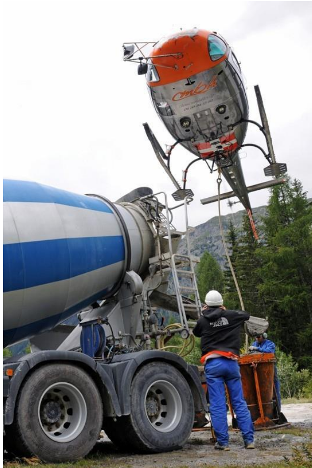
Imagen 6: Helicóptero AS 350 B3 en misión de transporte de carga colgante.
