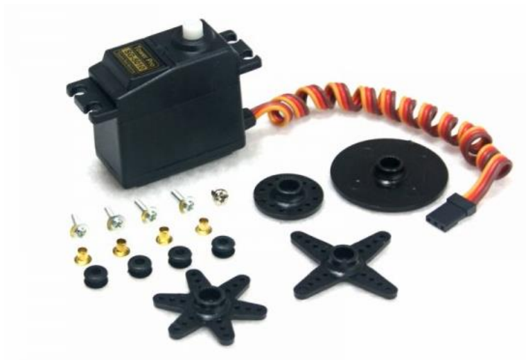
Figura 68: Imagen del Servomotor TowerPRO SG-5010, de Adafruit empleado en el sistema repartidos de filamentos. Fuente: https://www.adafruit.com/products/155
