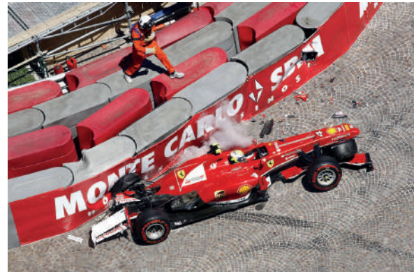
Figura 31: Barreras TECPRO para absorber los impactos.
