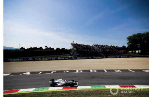
Figura 32: Trampa de grava para reducción de velocidad.
