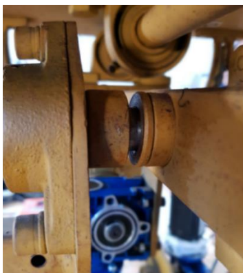
Figura 101: Espaciador de eje central que genera inestabilidad en el equipo.
