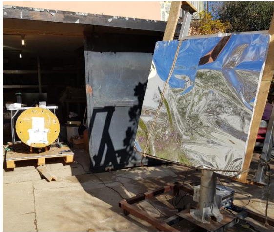
Figura 119: Heliostatos con lámina adhesiva reflectante.
