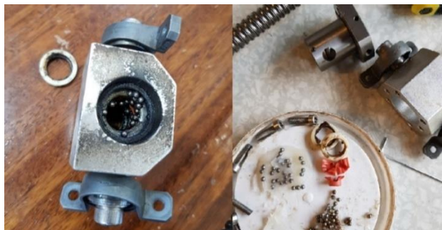
Figura 110: Estado inicial y reparación de rodamientos de bolas de husillos motrices.
