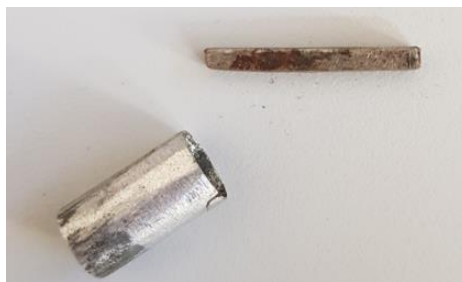
Figura 98: Camisa y chaveta que se extrajeron de los motores y caja reductora.
