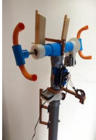
Figura 45: Estructura móvil superior del primero prototipo ensamblada en conjunto del sistema mecánico y sistema de seguimiento.
