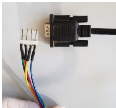
Figura 84: Cableado de salida stepper nema 23.
