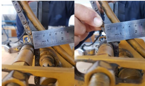
Figura 102: Problema en tensión de sistema de transmisión de eje de movimiento cenital.
