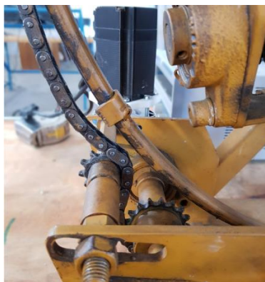
Figura 104: Posición de absoluto colapso del heliostato en su sistema de movimiento cenital.
