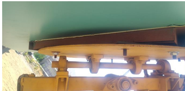
Figura 74: Cinta adhesiva doble contacto que permite adherencia entre cuadro de acero y espejo reflectante.
