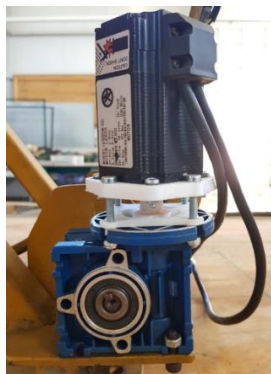
Figura 86: Motor paso a paso ensamblado a caja reductora mediante piezas impresas en impresora 3D.
