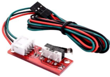
Figura 66: Interruptor final de carrera.
