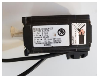
Figura 83: Motor paso a paso nema 23. Imagen corresponde a un motor defectuoso que se extrajo del heliostato de trabajo.
