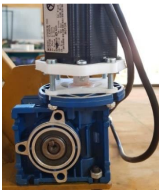
Figura 100: Montaje de piezas fabricadas en impresora 3D para ensamblaje de motor paso a paso y caja reductora.
