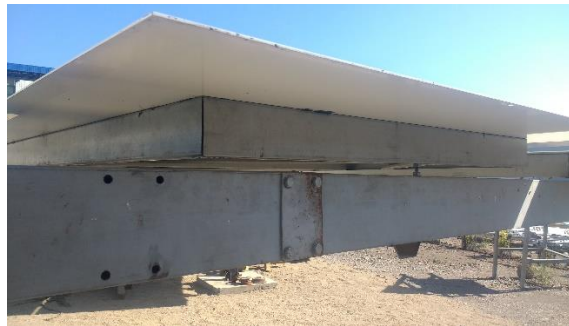
Figura 89: Soporte estructural inicial del panel reflector.
