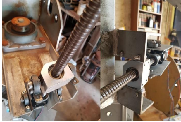
Figura 111: Ensamblaje de ambos sistemas motrices a heliostato. Izquierda, sistema cenital. Derecha, sistema azimutal.
