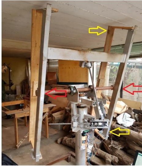
Figura 96: Puntos en donde las fuerzas aplicadas son más críticas para la operación del heliostato.
