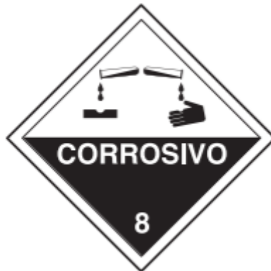
Figura 8: Distintivo Sustancias peligrosas clase 8 según NCh 2190/8
