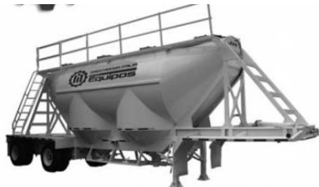
Figura 23: Silo Semirremolque fabricado por Maestranza Italia Ltda.
