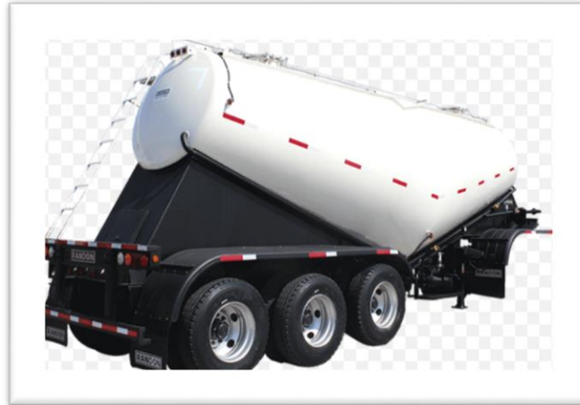
Figura 3: Semirremolque en V típicamente utilizando en la industria de cemento.
