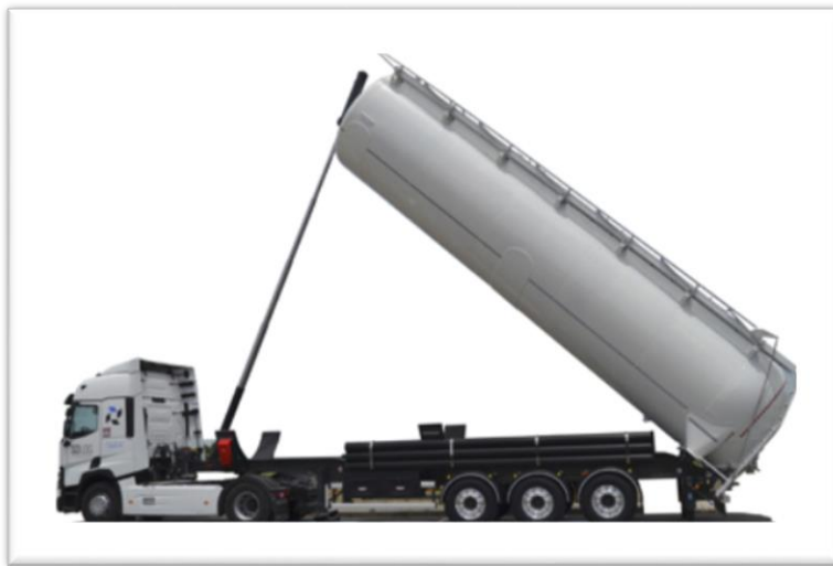
Figura 5: Semirremolque Silo “Tipping” Cilíndrico típico.
