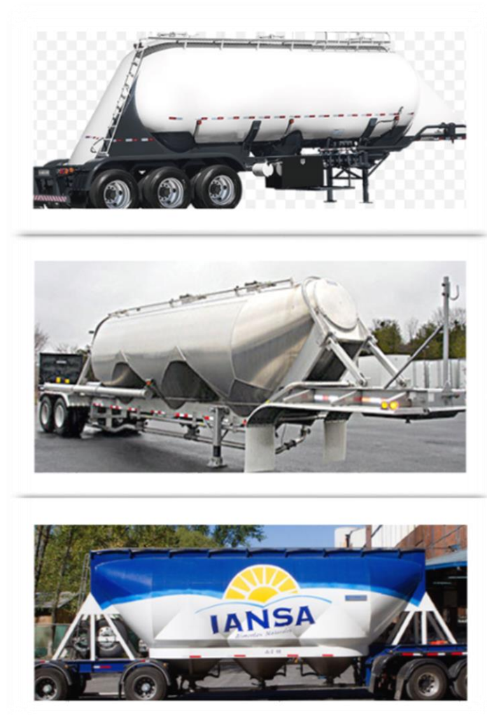
Figura 4: Diferentes silo semirremolques con Conos descarga a 45° utilizados en la industria nacional
