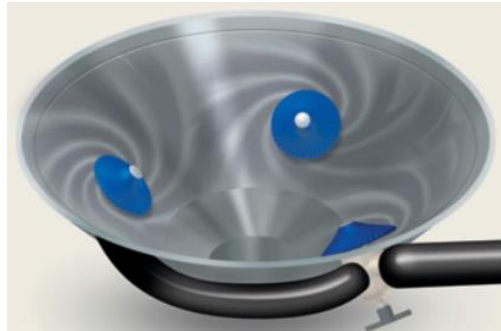
Figura 16: Sistema de Aireadores en tolva de descarga, (BTI, 2018)
