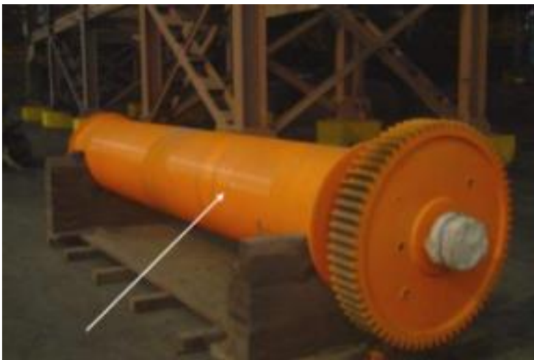
Fuente: Archivo Fundición Ilo Figura 1-9. Tambor principal de izamiento
