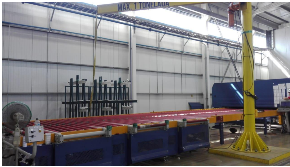
Ilustración 7 Equipo laminado o "Calandra".
