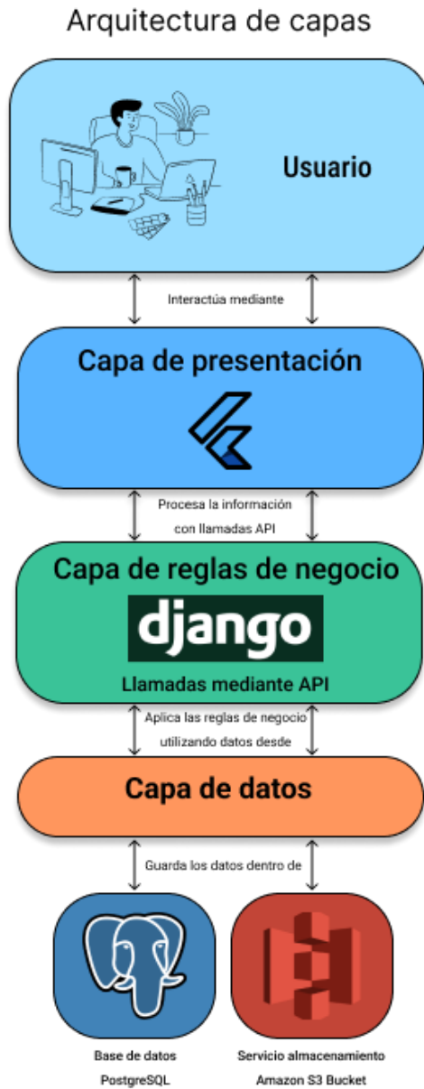
Figura 3–1. Diagrama de arquitectura de capas
