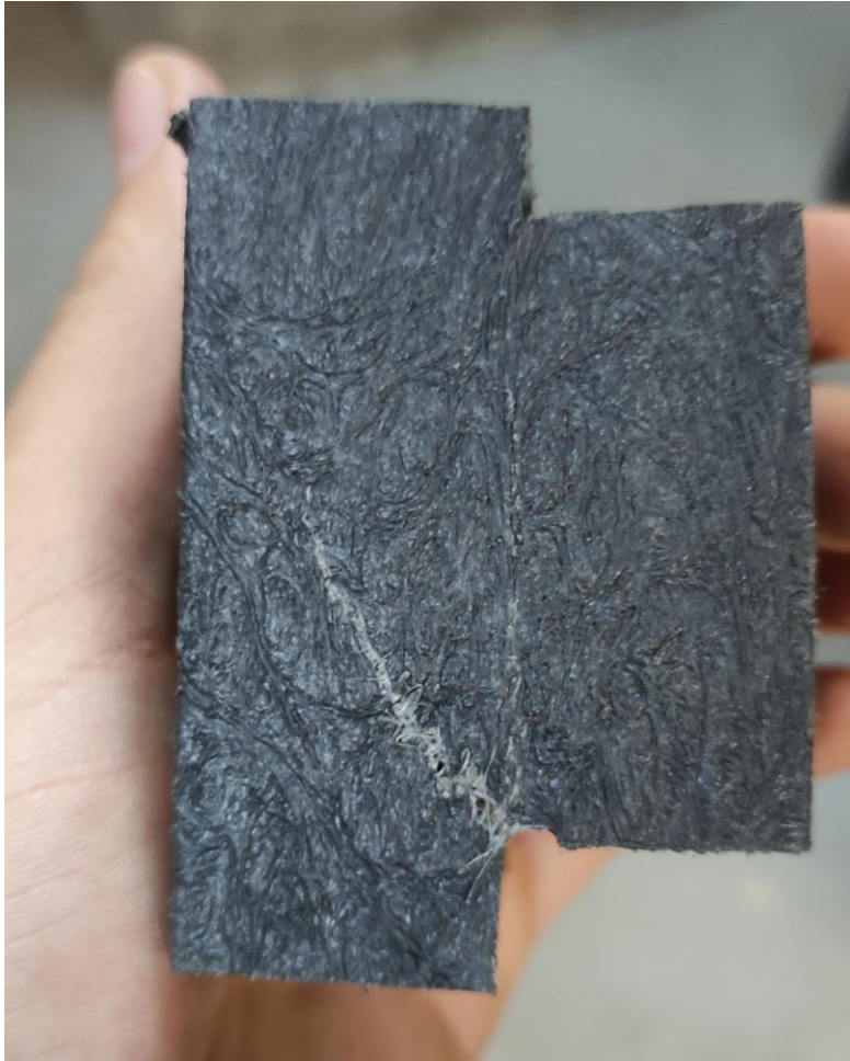
Ilustración 26: Falla al corte. Fuente: fotografía propia en laboratorio LEMCO. Valparaíso, Chile
