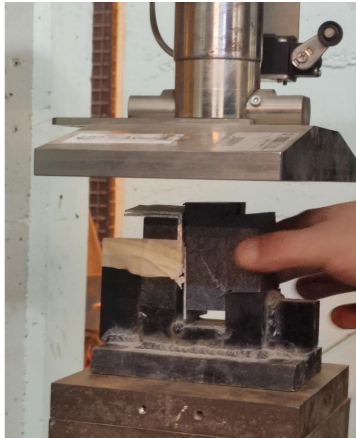
Ilustración 23: Ensayo cizalle. Fuente: fotografía propia en laboratorio LEMCO. Valparaíso, Chile.
