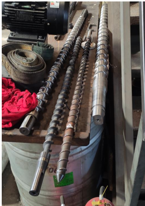
Ilustración 25: Husillo extrusores. Fuente: fotografía propia en empresa que fabrica hilos extrusores. Santiago, Chile.
