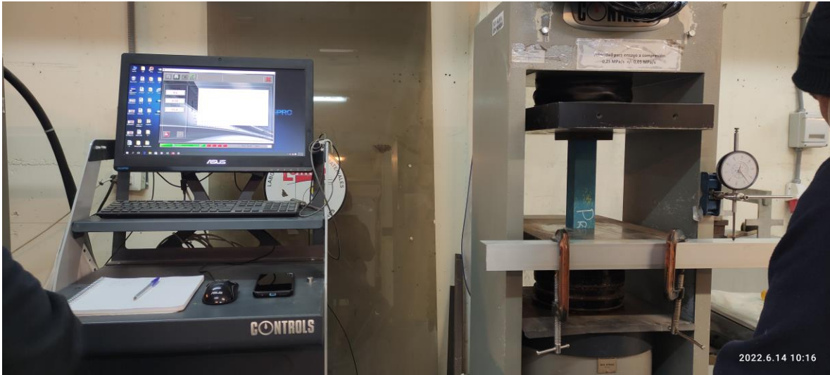
Ilustración 22: Ensayo compresión paralela. Fuente: fotografía propia en laboratorio LEMCO. Valparaíso, Chile.
