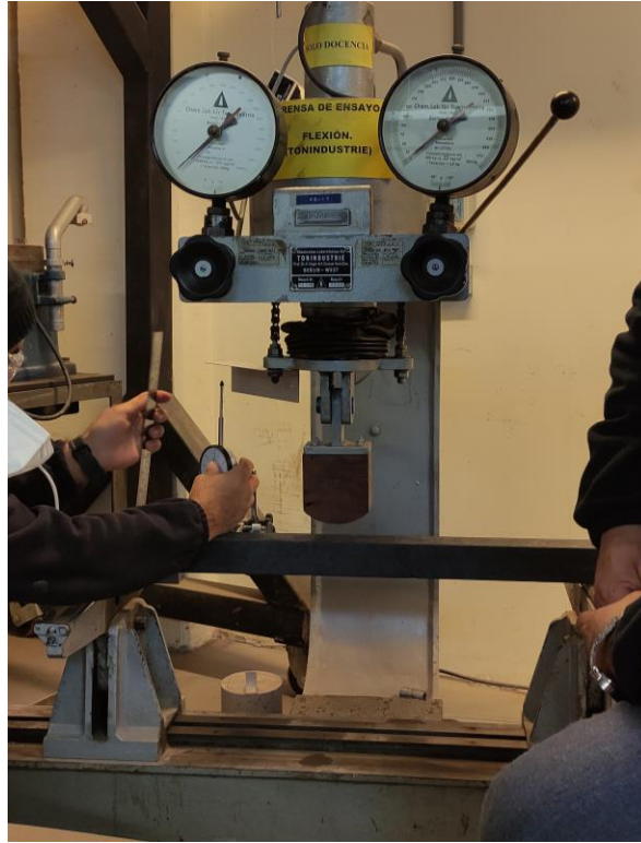
Ilustración 24: Ensayo flexo-tracción. Fuente: fotografía propia en laboratorio LEMCO. Valparaíso, Chile.
