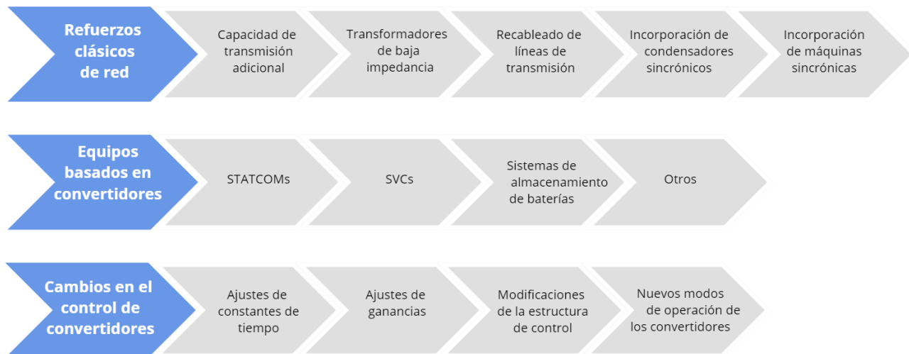
Figura 2.9: Alternativas para modificar la robustez de un SEP [4].
