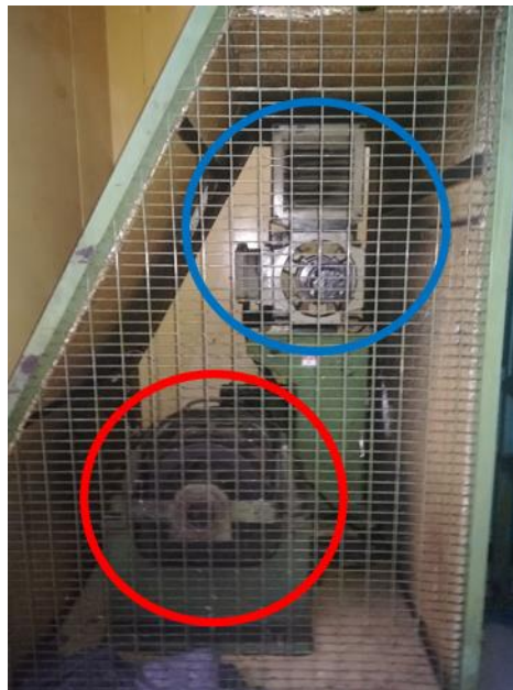
Imagen 15: Motor trifásico (azul) y freno eléctrico (Rojo)
