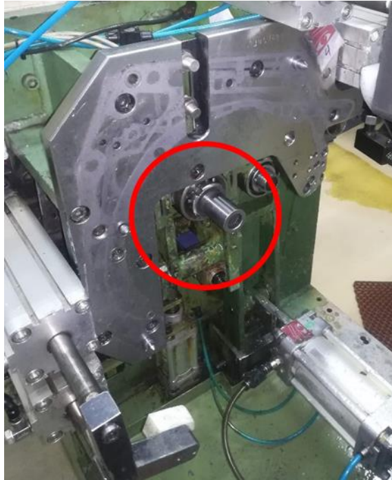
Imagen 13: Fotografía que destaca, en un círculo rojo, el acople punta de motor
