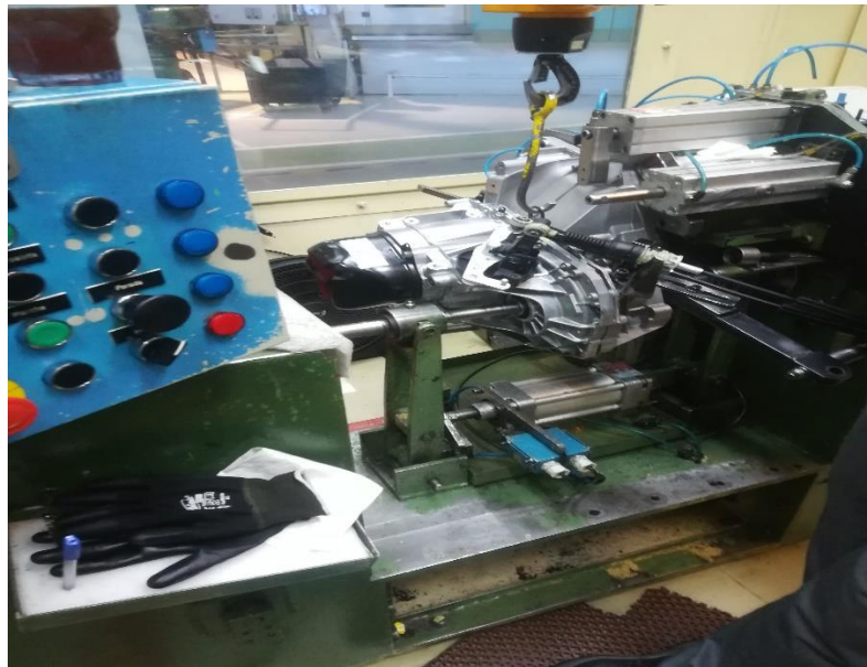
Imagen 10: Fotografía del banco de pruebas realizando un control a una caja de velocidad.
