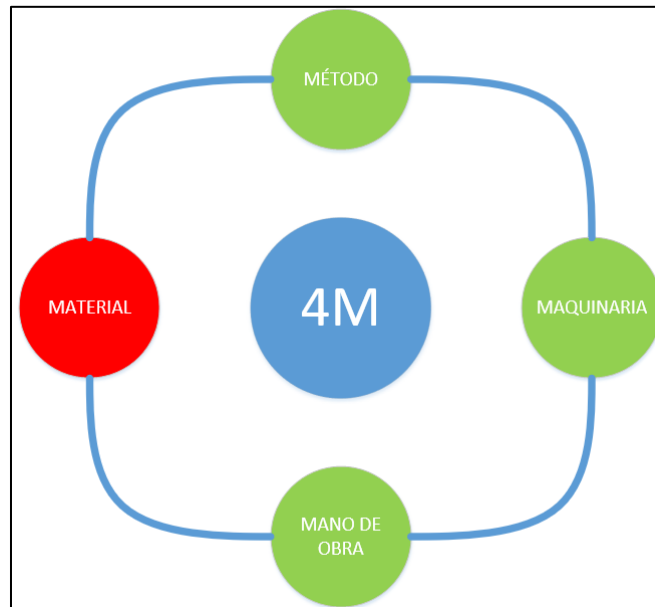
Imagen 25: Esquema de las 4M para el análisis de la causa raíz.
