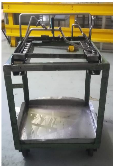
Imagen 19: Carro con dispositivo anexo para el traslado de cajas de cambio
