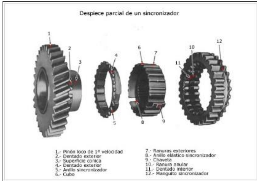
Imagen 7: Despiece del conjunto sincronizador, cubo y collarín, o desplazable.
