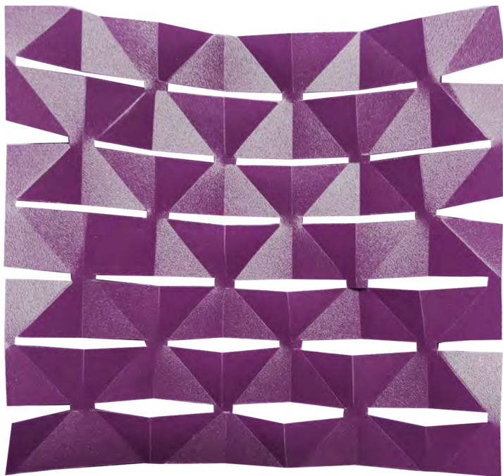
Fig. 58. Segunda prueba de plegado del patrón kirigami piramidal en una mica opaca 300 \mu\text{m} . Fuente: Elaboración propia (2026).
