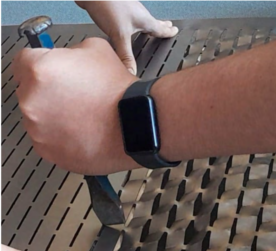
Fig. 76 Proceso de plegado con cincel de la plancha de acero laminado. Fuente: Elaboración propia (2026)
