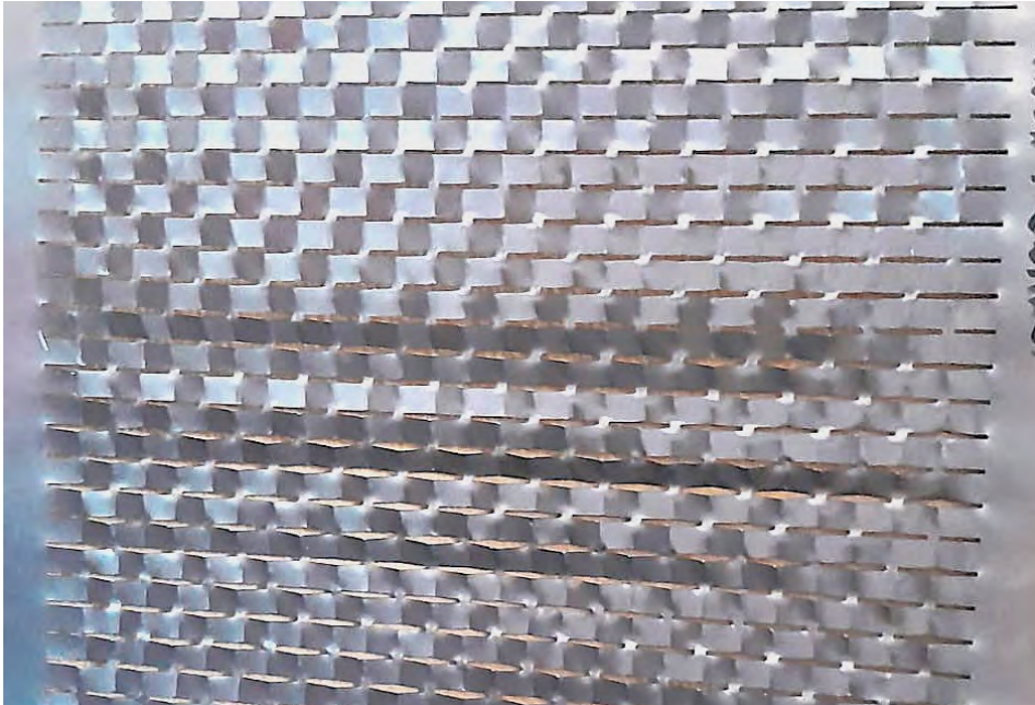
Fig. 74 Lámina acero laminado plegada con geometría kirigami piramidal. Fuente: Elaboración propia (2026)
