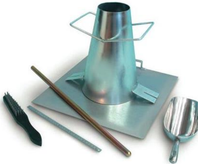
Figura 18: Cono de Abrams utilizado comúnmente en pruebas de laboratorio (Vallejos 2017).
