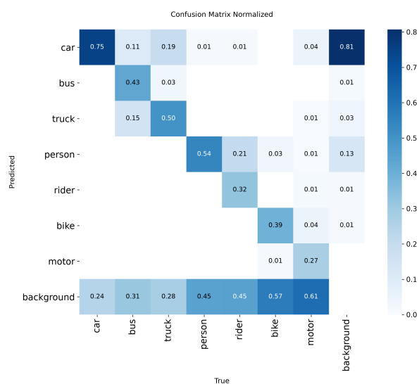
Figura 34a. Matriz de confusión normalizada, YOLO11n: filas = clase predicha, columnas = clase real; la diagonal principal muestra la tasa de detección correcta por clase; la fila “background” representa los falsos negativos. Fuente: elaboración propia.
