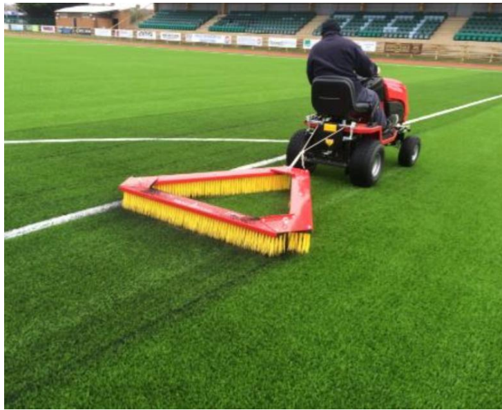
Figura 4-8. Ejemplo de cepillado y descompactación de césped sintético. Modelo: REDEMIX VERTI-BROOM 1850.
