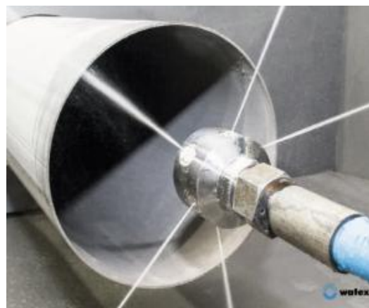
Figura 4-11. Ejemplo de cabezal de limpieza tipo hidrojet para sondeo de tuberías. Fuente: Elaboración propia (IA).
