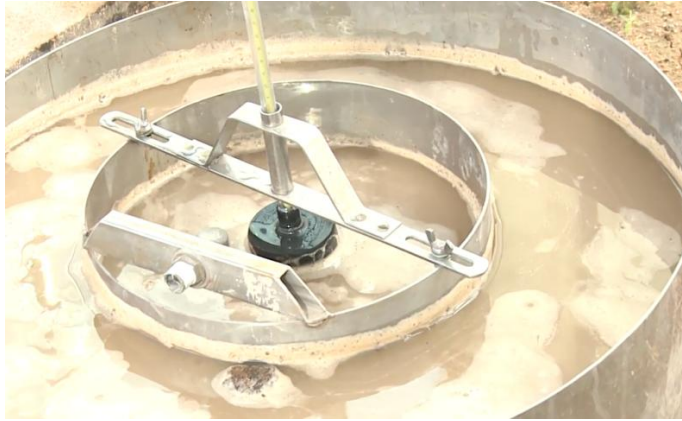
Figura 1-4. Ensayo de infiltración tipo Porchet.
