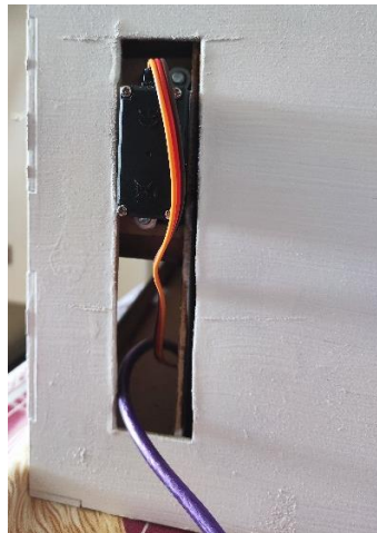
Figura 32-3. Leva encargada de empujar para dispensar las cajas
