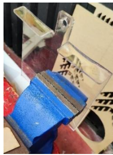
Figura 22-2. Unión de piezas ya cortadas con cola fría para madera
