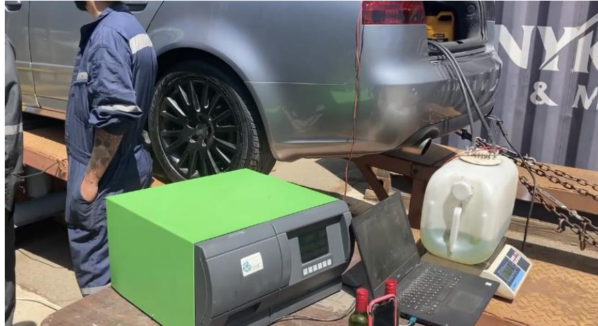
Figura 24: Equipo analizador de gases BOSCH BEA 250.
