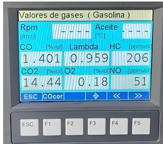
Figura 14: Pantalla de equipo analizador de gases Bosch BEA 250.
