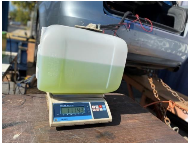
Figura 17: Estanque de combustible externo sobre la balanza digital.
