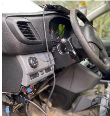
Figura 21: Herramienta de comunicación KESS V2 conectado mediante puerto OBD2.
