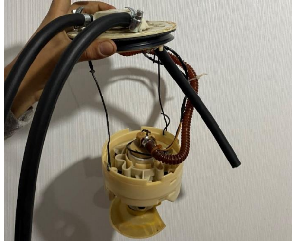
Figura 18: Bomba de combustible original Audi utilizada en estanque de combustible externo.
