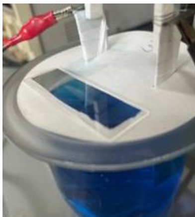
Figura 16: Montaje de experimento de electro obtención a escala.
