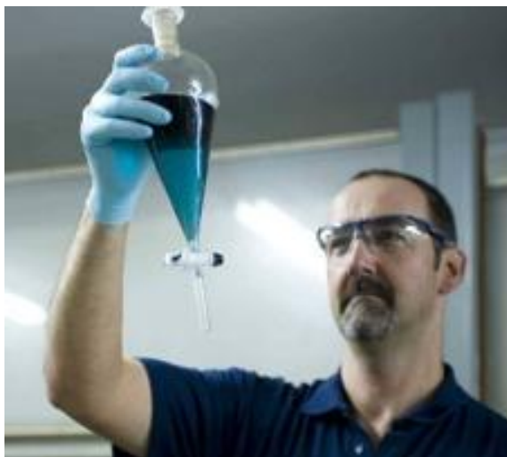
Figura 39: Separación de fase orgánica y acuosa en experimento de extracción por solventes a escala de laboratorio.
