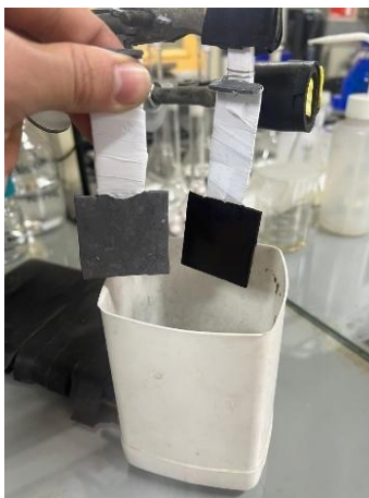
Figura 13: Comparativa entre ánodo virgen y ánodo pasivado.
