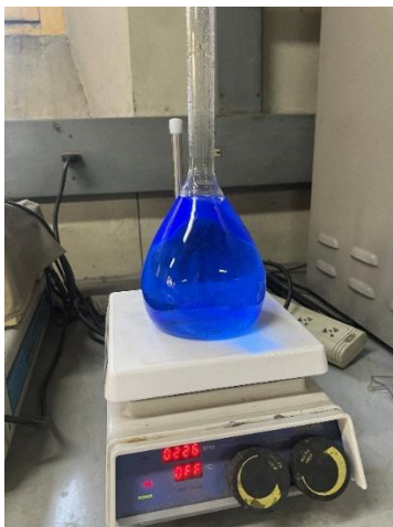
Figura 9: Solución exitosa de sulfato de cobre pentahidratado (tercer intento).
