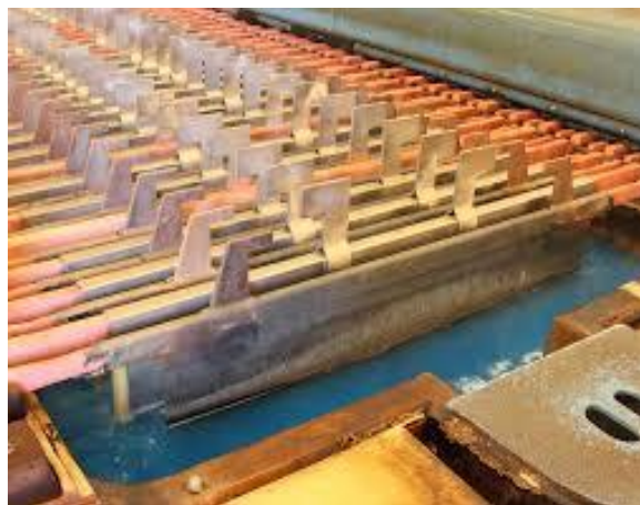
Figura 34: Nave de electro obtención industrial.
