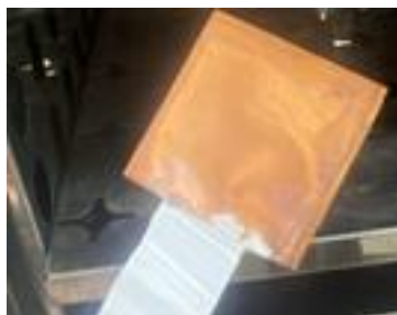
Figura 32: Formación costra en cátodo de experimento 1 del grupo B.
