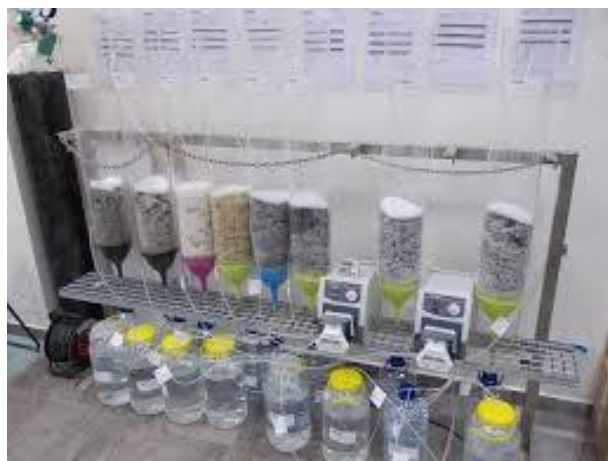
Figura 38: Experimento de lixiviación en columnas a escala de laboratorio.
