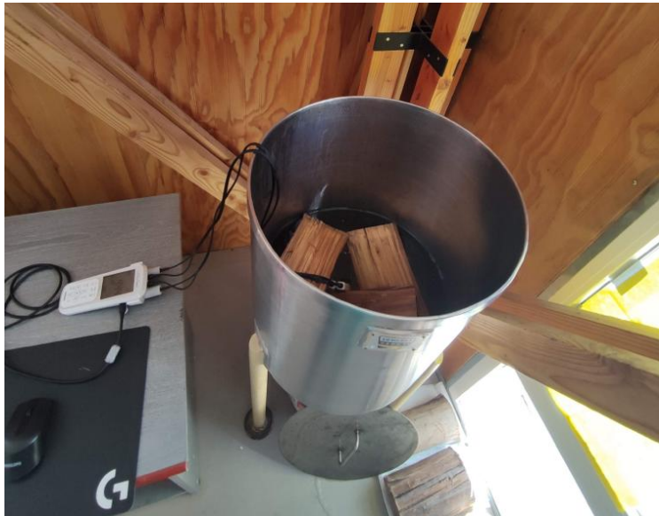
Figura 21: Silo de maceración con leños y equipo de medición
