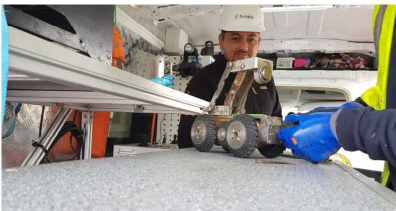
Fotografía N°2: Preparación de Cámara robótica
