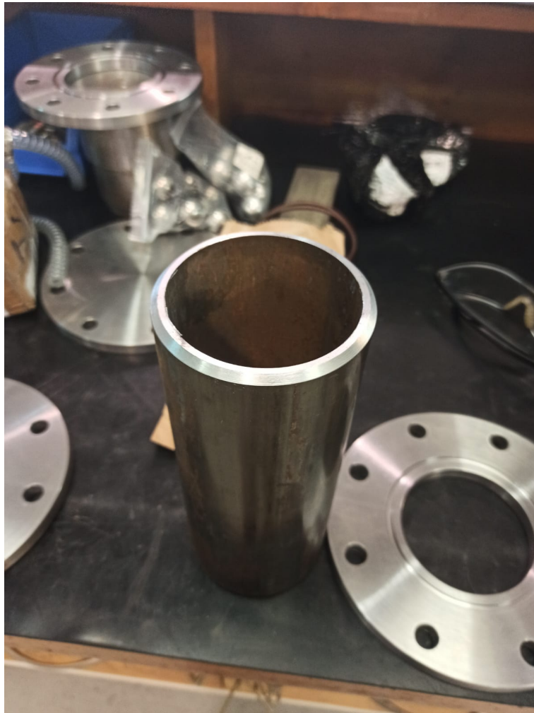
Figura 5.12: Mecanizado extremo al manto.
