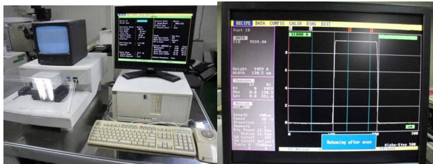
Figura 2-10 Perfilómetro Alpha-Step 500 y su perfil ((KLA / TENCOR Alpha Step 500 Wafer Tester Used for Sale Price #9181207 > Buy from CAE, 2025.))
