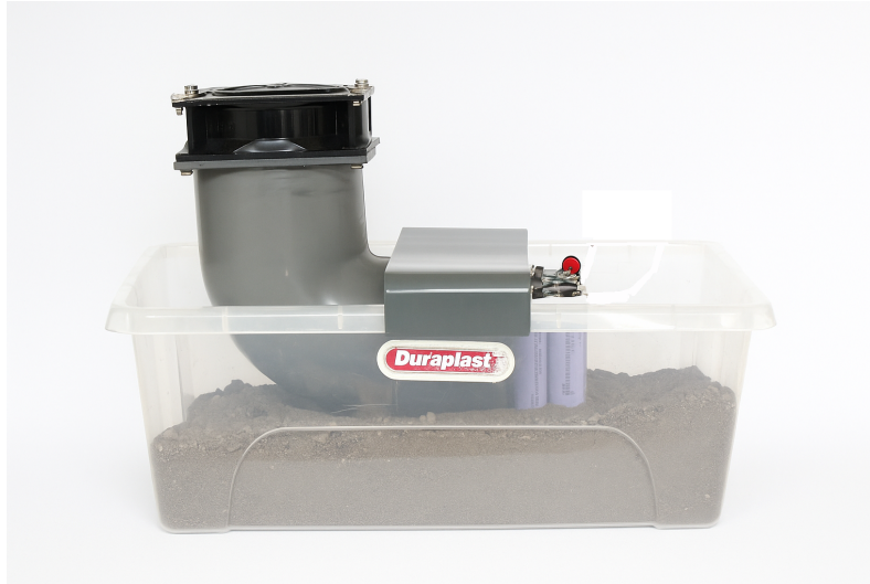
Figura 6.9. Montaje del sistema de refrigeración por convección forzada.
