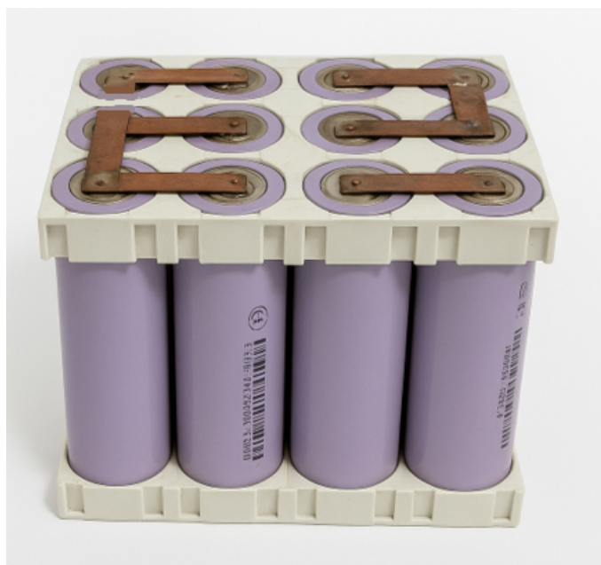
Figura 6.1. Módulo de baterías 6s2p.
