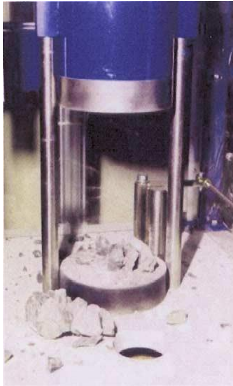
Figura 2.7 Estructura de equipo Drop-weight tester.
