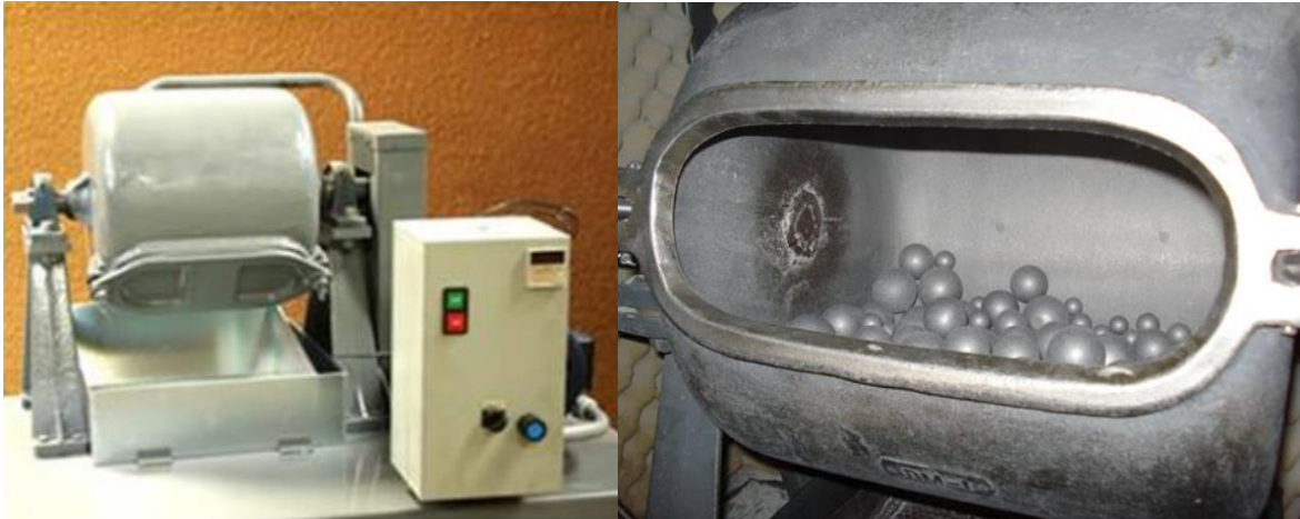
Figura 2.13 Equipo Índice de Trabajo de Bond.
