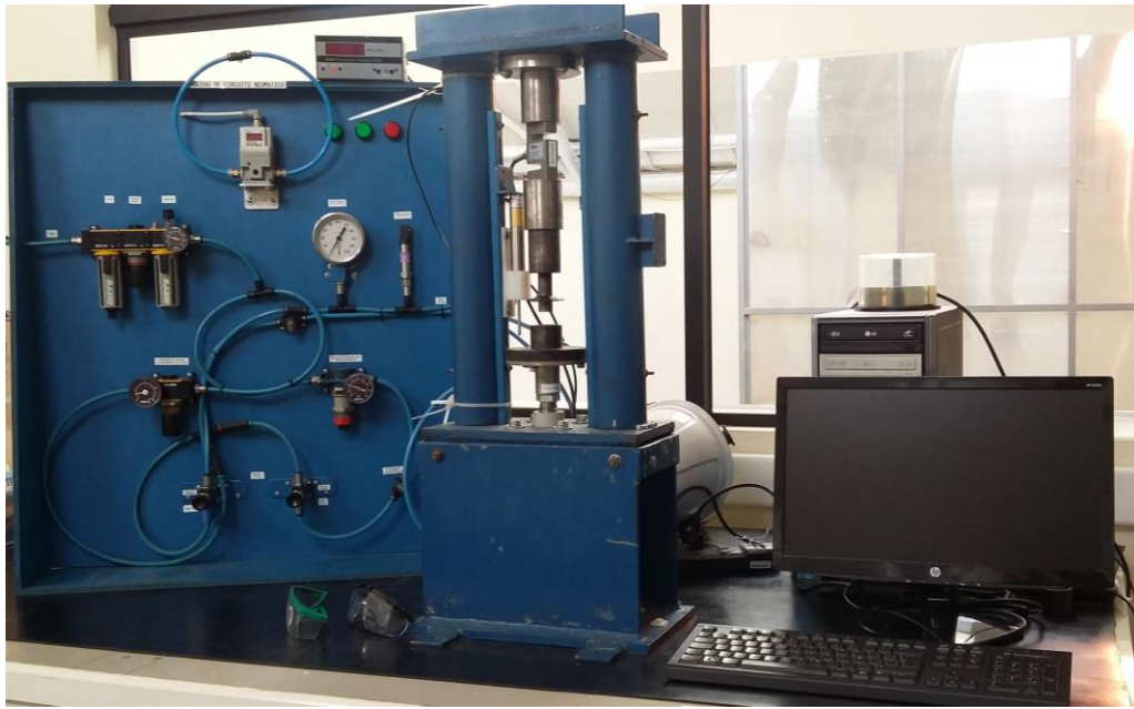
Figura 4.8 Prensa neumática instrumentada.
