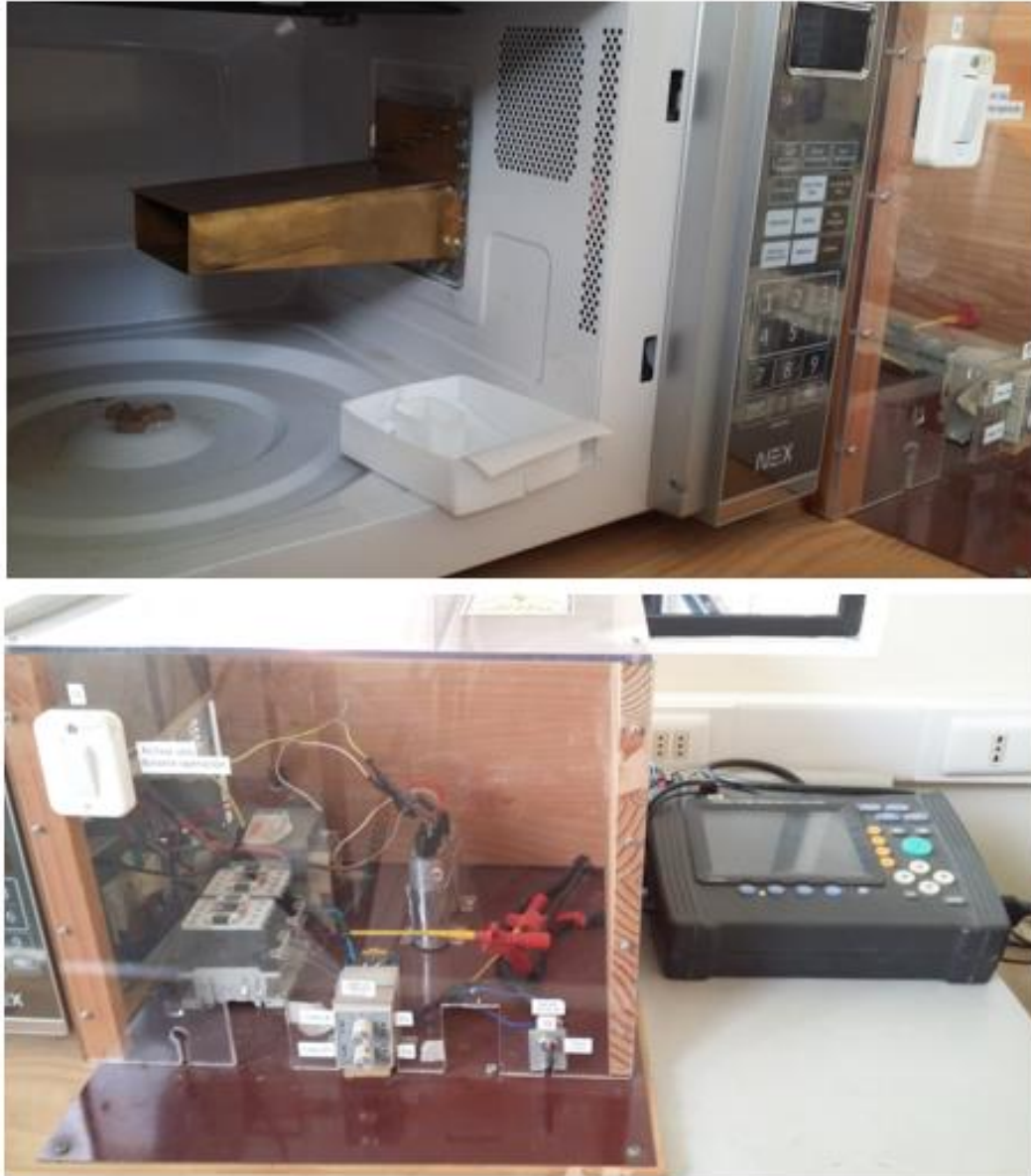
Figura 4.6 Microondas modificado, Control de pulsos de microondas e Instrumento de medición y registro de pulsos de microondas.
