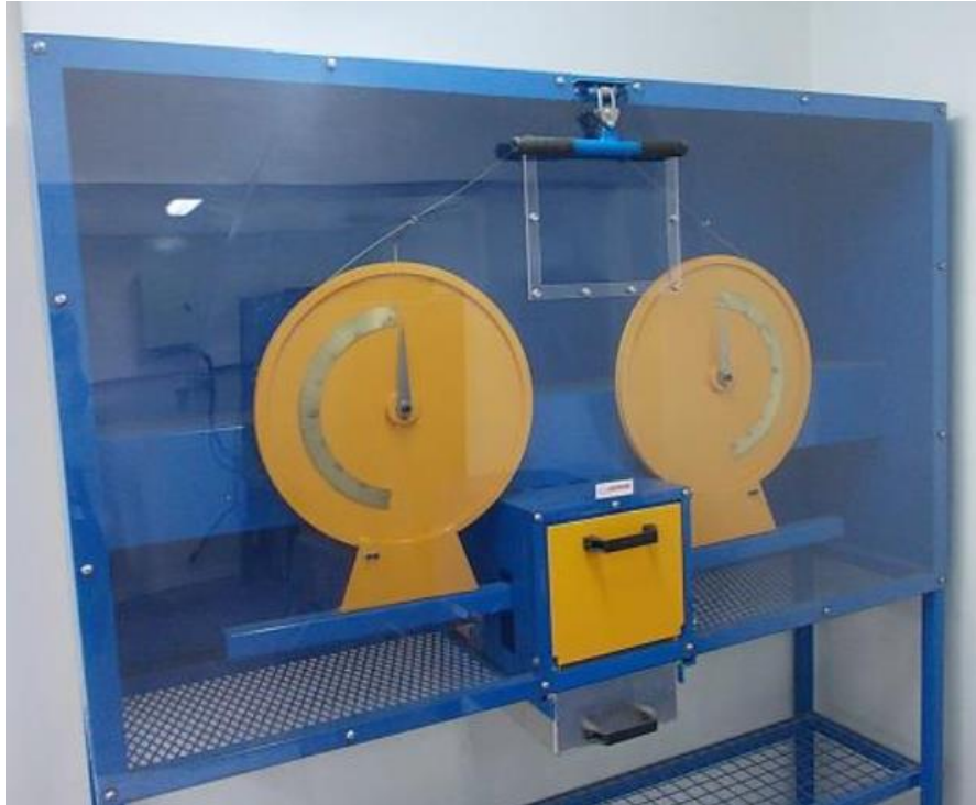
Figura 2.2 Equipo de Impacto de Bond.
