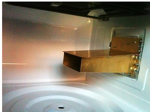
Figura 4.1 Microondas modificado con guía de ondas incorporada en su interior.
