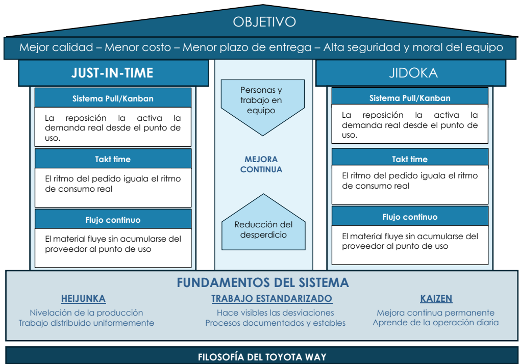
Figura 2.1. La Casa del Toyota Production System: estructura conceptual del sistema. Fuente: elaboración propia con base en Liker (2004).
