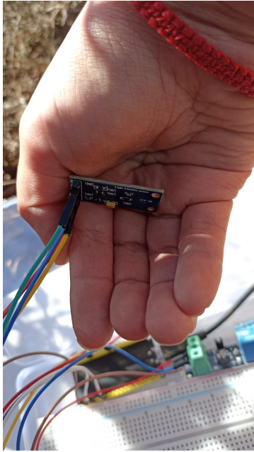
Figura 3.27: Sensor BH1750 con sombra forzada
