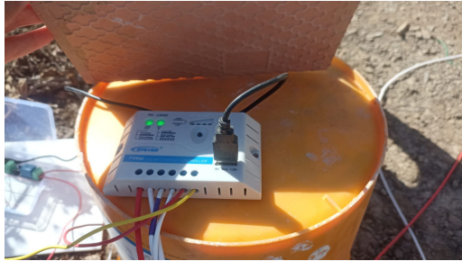
Figura 3.20: Controlador de carga
