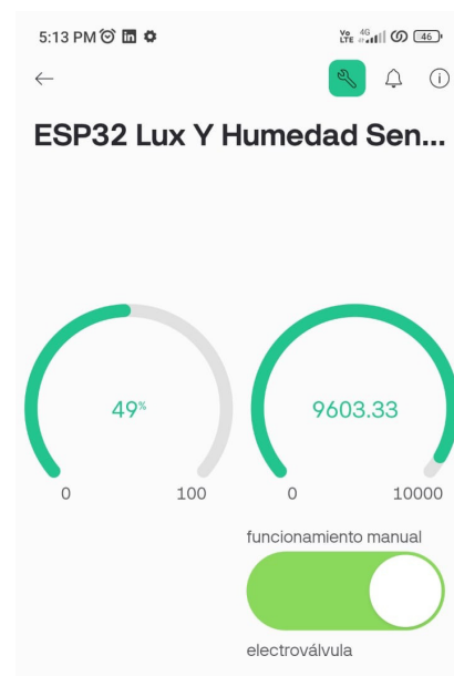
Figura 3.26: Medición Blynk sensores con sol directo
