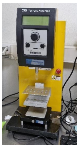
Figura 22. Equipo y sonda utilizada en prueba de compresión.
