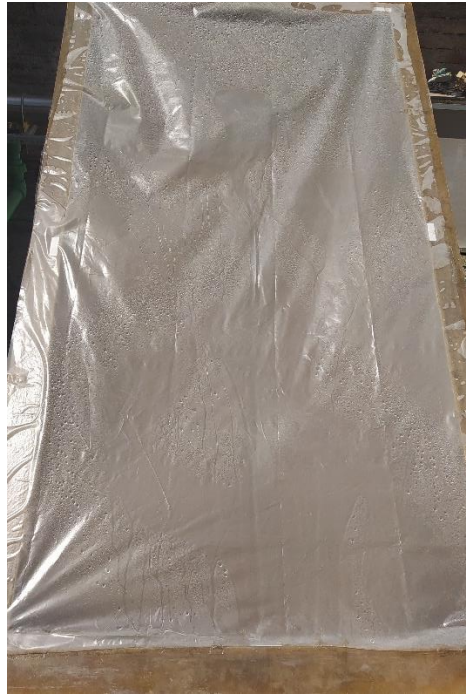
Figura 5- 1. Vista frontal de la cámara de humidificación con los rociadores en funcionamiento.
