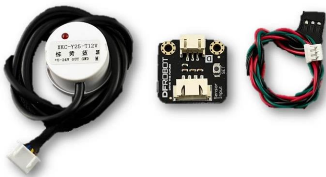
Figura 3- 40. Sensor de nivel de líquido sin contacto. Fuente: [35].
