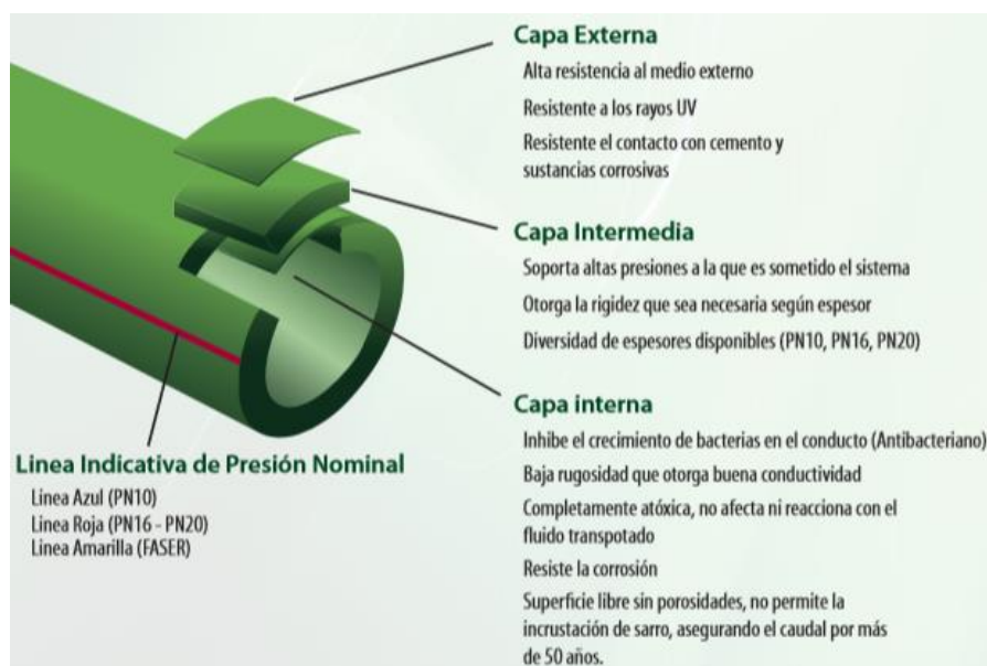
Figura 3- 17. Descripción de las tuberías de PPR utilizadas. Fuente:[28].
