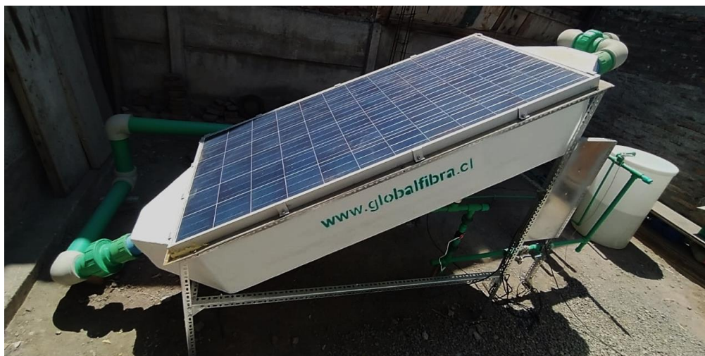
Figura 5- 2. Montaje final del desalinizador HDH.
