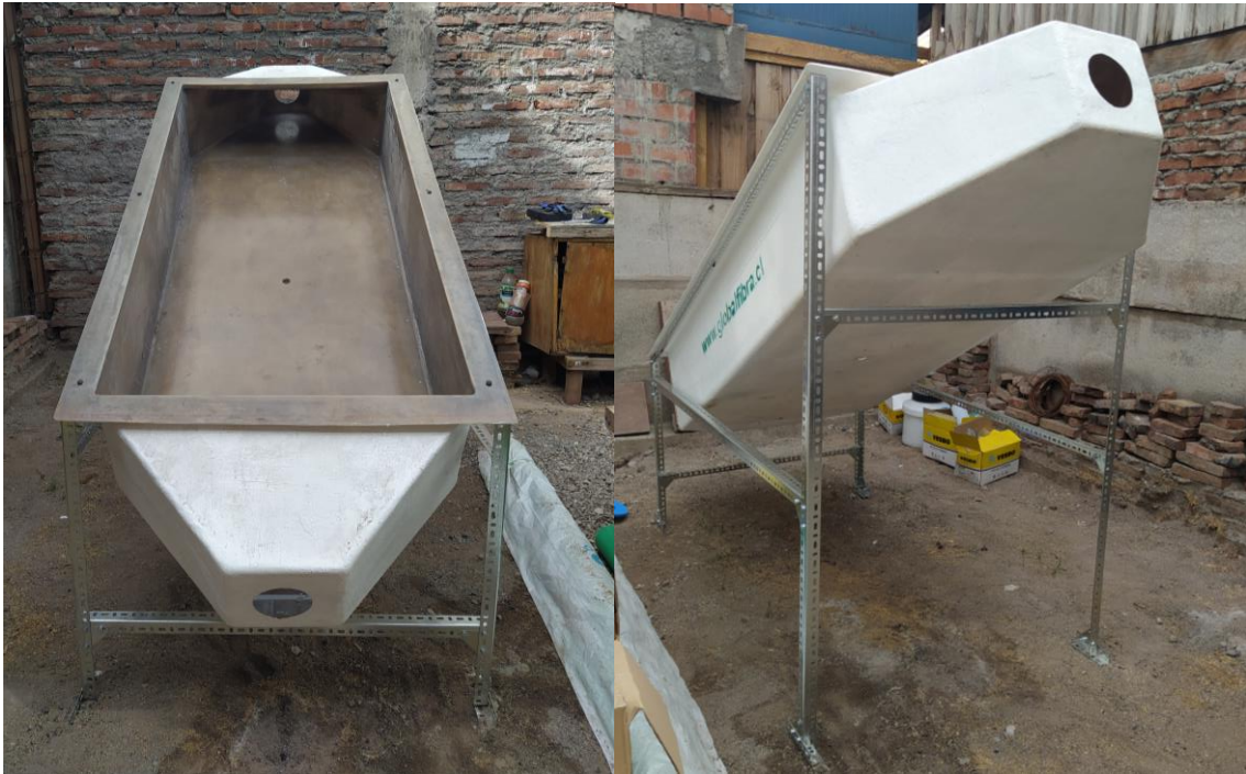
Figura 4- 3. Vista Frontal y trasera de la cámara de humidificación.
