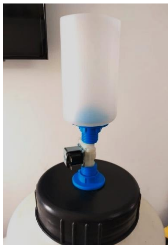
Figura 4- 22. Botella graduada junto con el solenoide y el estanque de agua pura.
