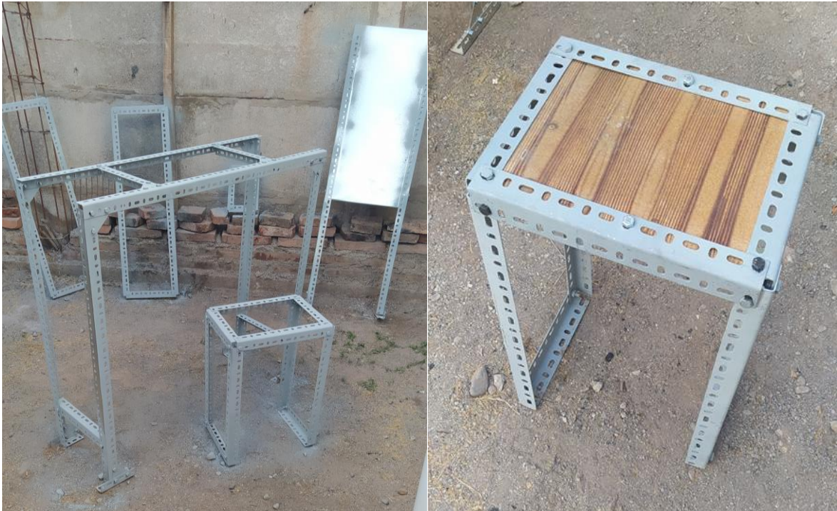
Figura 4- 2. Estructuras del deshumificador, la unidad de filtrado, calentador de agua, soportes y el extractor de aire.
