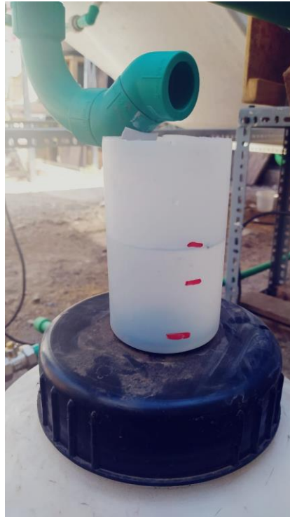
Figura 5- 3. Destilado de agua pura. La primera línea corresponde al comienzo de la prueba, la segunda a la hora de funcionamiento y la tercera al término de la prueba.
