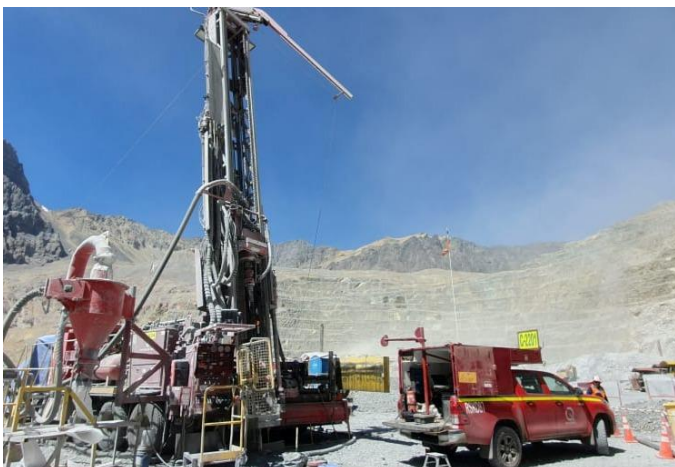
Figura 2-4: Camioneta Q.S.S. realizando medición en sondaje Aire – Reverso (RC).
