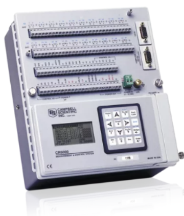
Figura 3.13: Datalogger de la empresa Campbell Scientific©CR5000 [122].
