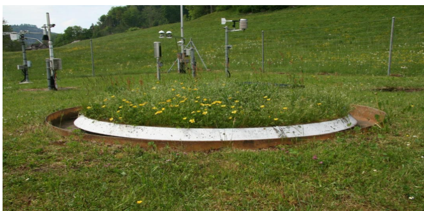
Figura 4.6: Lisímetro instalado en un terreno de una localidad de Suiza. La vegetación de la muestra aislada con la de exterior es la misma, a fin de obtener mediciones exactas [5].
