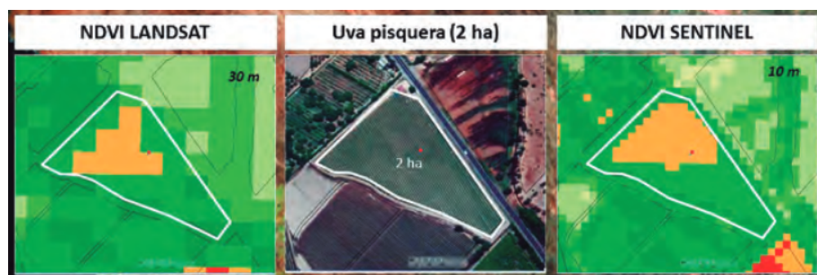
Figura 3.15: Comparación entre los métodos de teledetección de parrón de uva pisquera del valle de Elqui. A la izquierda, la configuración de Landsat y a la derecha, mediante Sentinel [95].
