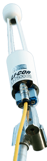
Figura 3.10: Analizador de gas infrarrojo CO 2 /H 2 O de la empresa LICOR©LI-7500 [80].
