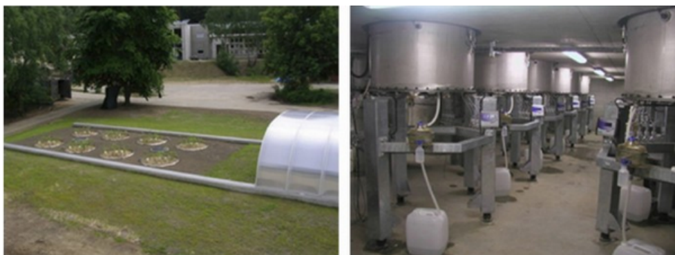
Figura 4.9: Lisímetro de peso con vista en el exterior y debado de este.
