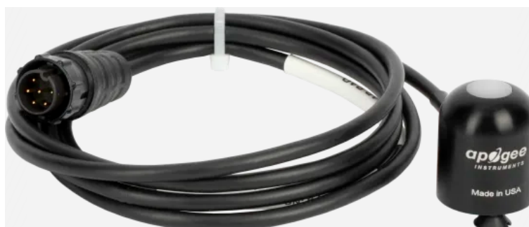
Figura 3.5: Sensor de radiación solar de la empresa Campbell Scientific©, modelo CS305 [128].
