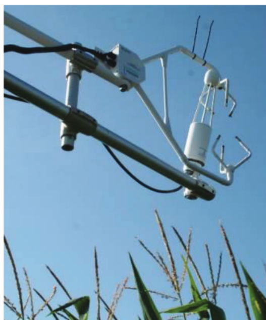
Figura 3.1: Sistema de medición de covarianza de vórtices que consiste en un anemómetro sónico tridimensional (CSAT-3, Campbell Scientific Inc., Logan, UT) y un analizador de gases infrarrojo (LI-7500, LI-COR Biosciences, Lincoln, NE) [99].
