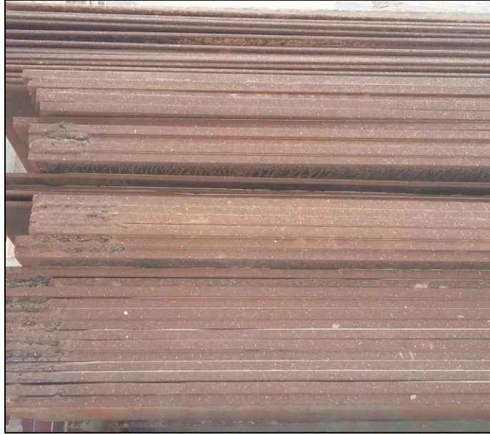
Figura 2-6. Planchas del contrapeso CV-111.
