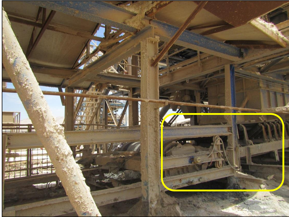
Figura 2-16. Deformación carro tensor CV-113.
