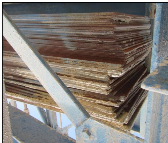
Figura 2-18. Planchas del contrapeso CV-114.
