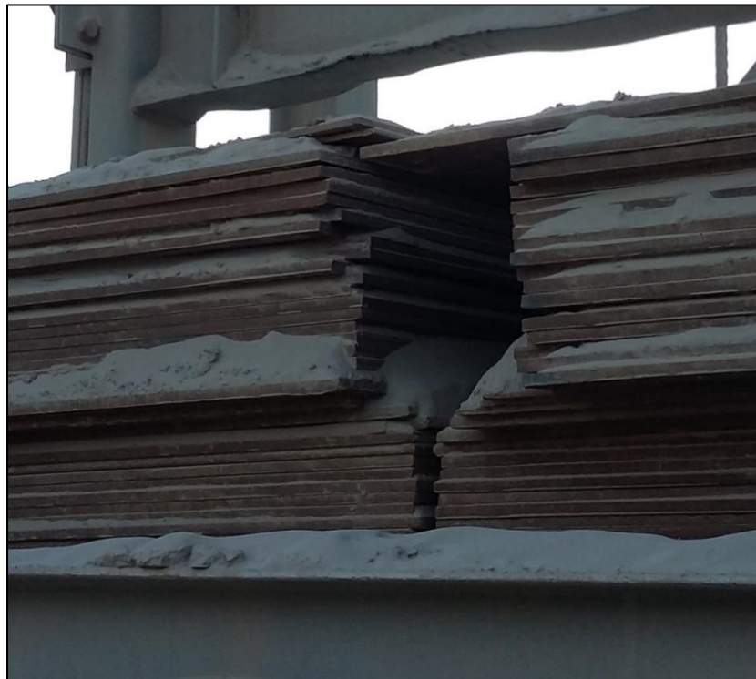
Figura 2-9. Planchas del contrapeso CV-112.
