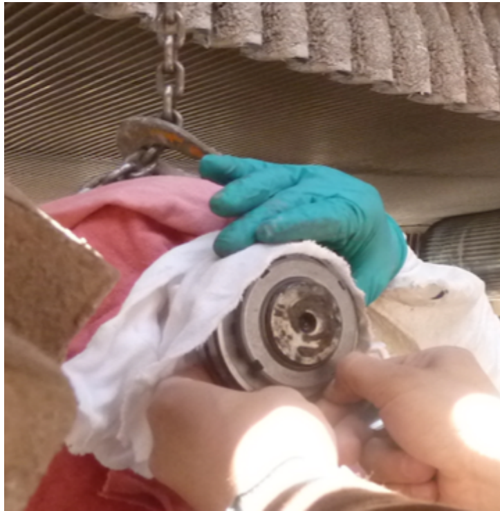
Figura 2.65 Medición del juego radial interno residual en la zona descargada del rodamiento.
