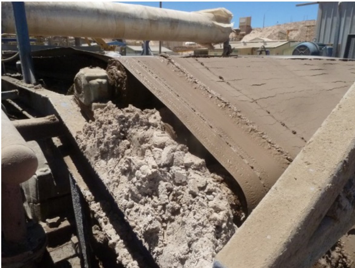
Figura 2.8 Zona superior del filtro de banda, con alta contaminación de partículas sólidas pertenecientes al proceso de filtrado.
