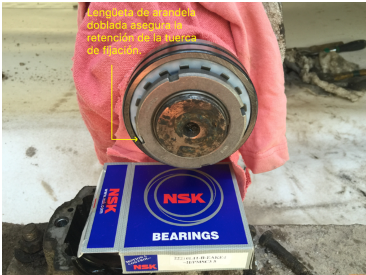
Figura 2.67 Lengüeta de arandela de retención doblada asegura la fijación de la tuerca.
