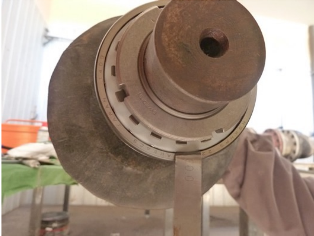
Figura 2.49 Juego radial interno residual correspondiente a 0.03 [mm].
