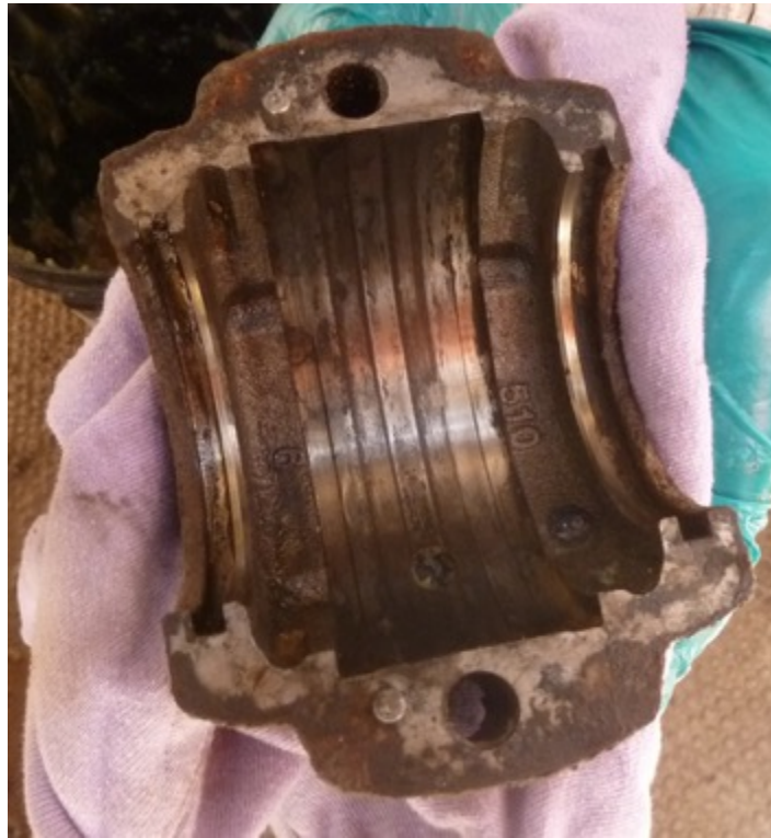
Figura 2.69 Inspección del estado del alojamiento de la tapa del soporte.
