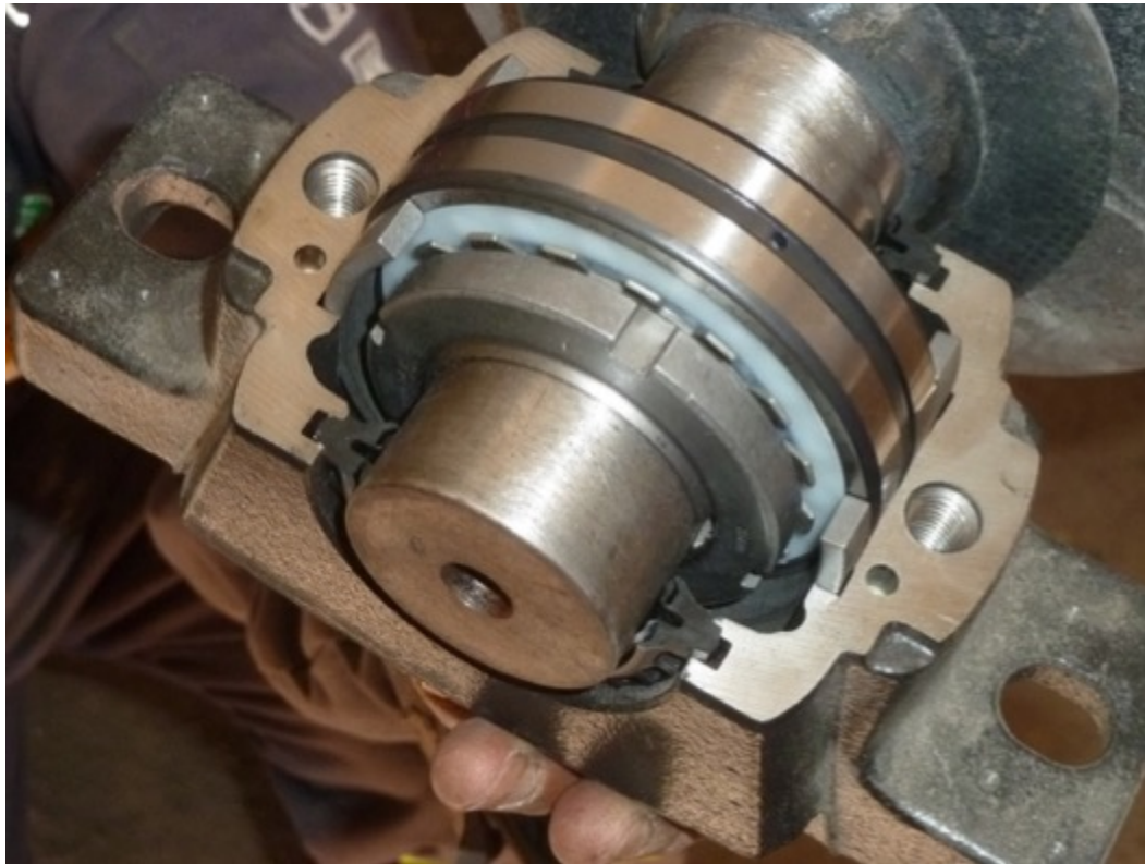
Figura 2.52 Conjunto armado y posicionado en el eje.
