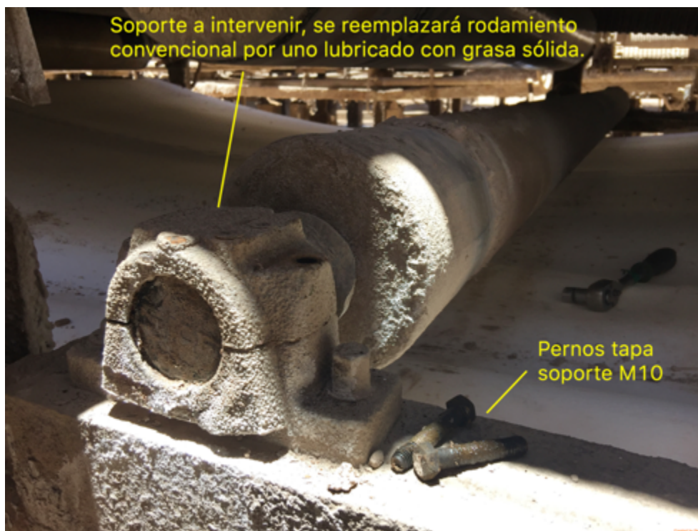
Figura 2.56 Soporte lado fijo del rodillo número 11T.
