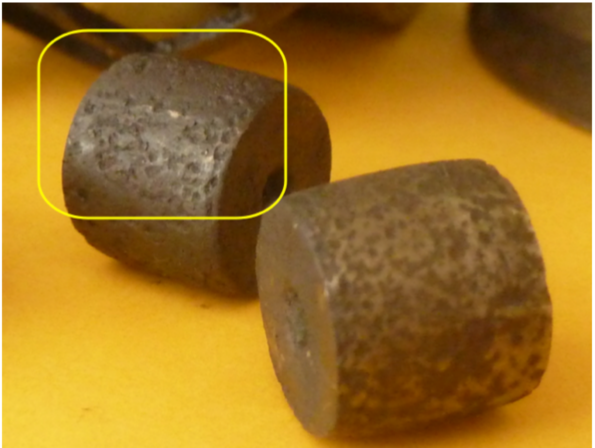
Figura 2.20 Rodillos esféricos llenos de micro cráteres.
