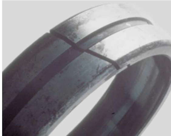
Figura 1.61 Fractura de fatiga en un aro exterior de un rodamiento de rodillos esféricos.
