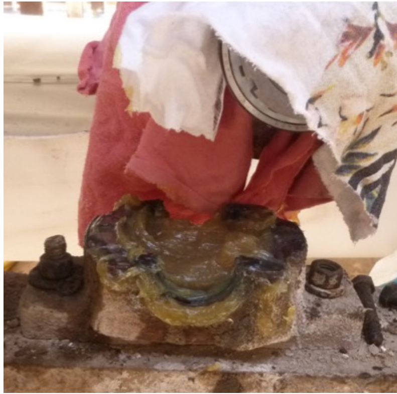
Figura 2.70 Montaje de obturaciones partidas en el soporte y posterior engrase.
