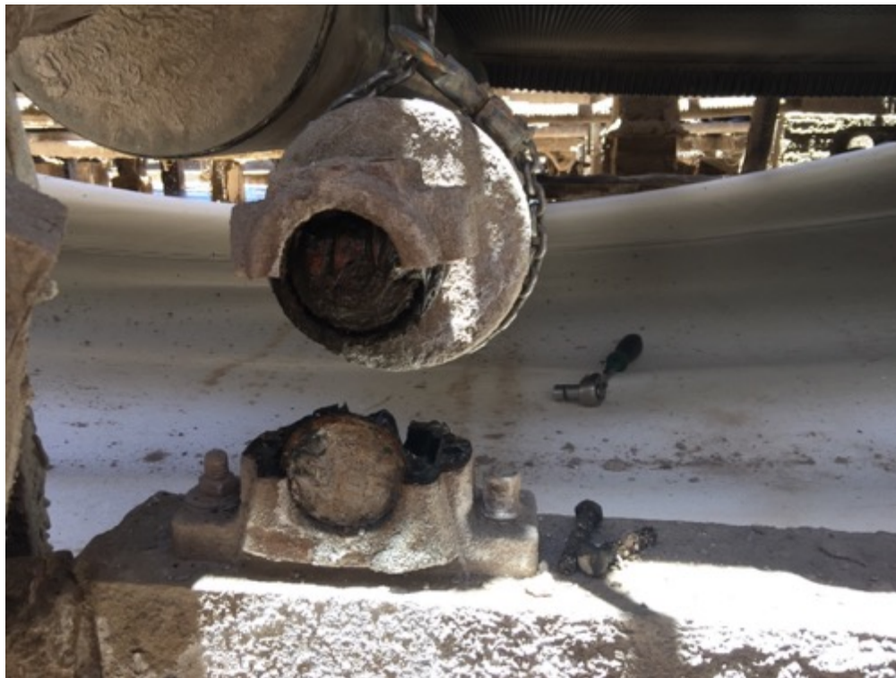
Figura 2.57 Extracción del rodillo hacia arriba mediante un tecle.
