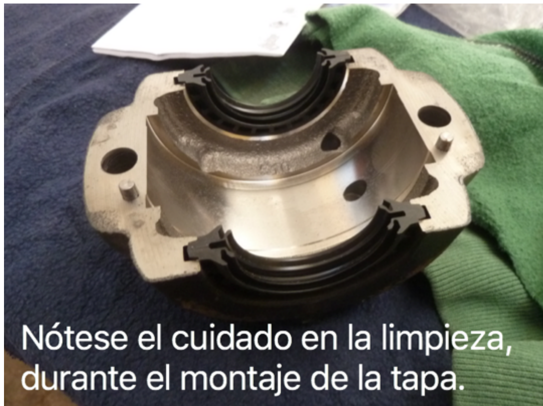
Figura 2.54 Ambas obturaciones partidas instaladas en la tapa del soporte.
