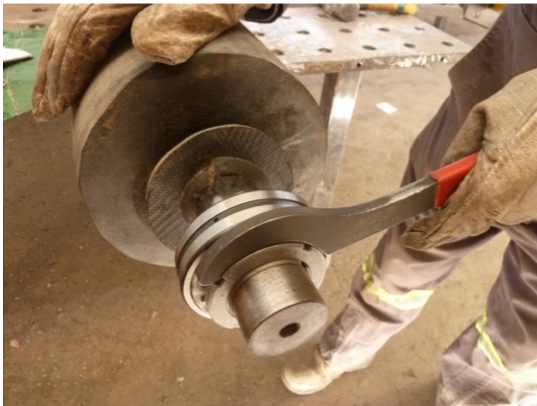
Figura 2.47 Apriete de la tuerca de fijación por medio de llave de gancho.
