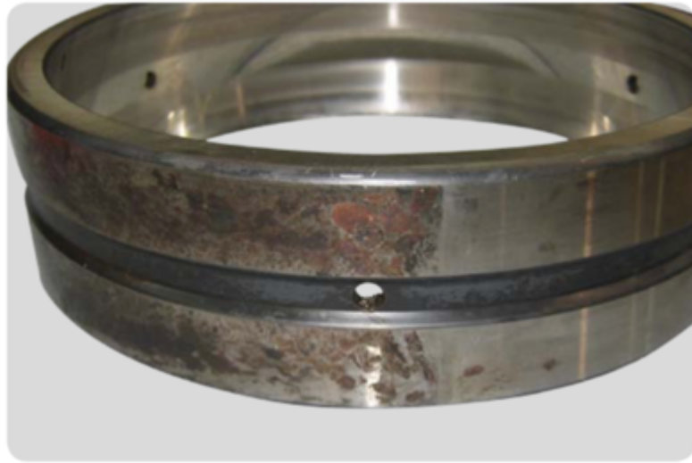
Figura 1.70 Aro exterior rodamiento de rodillos esféricos.
