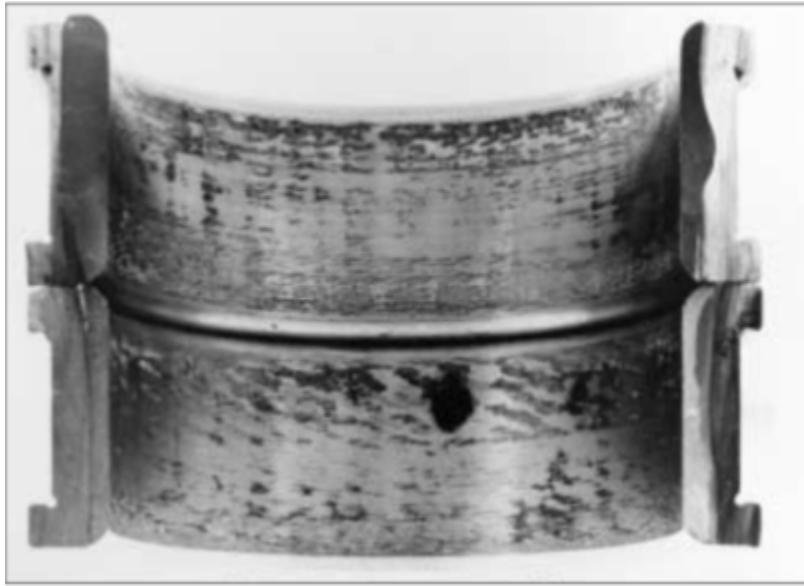
Figura 1.69 Aro interior de un rodamiento de rodillos cilíndricos.
