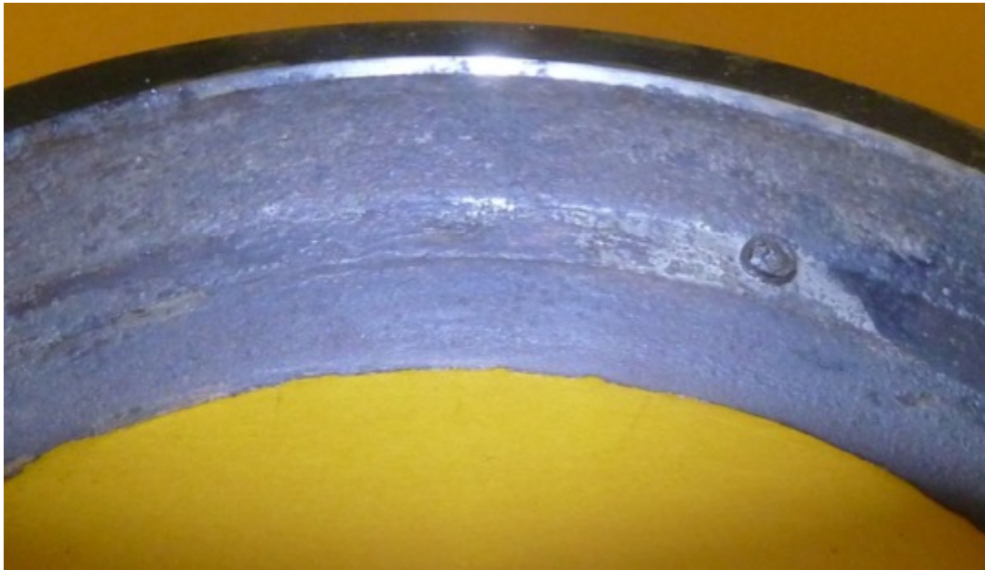
Figura 2.19 Zoom revela micro cráteres en la pista de rodadura del aro exterior.
