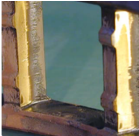
Figura 1.54 Desgaste abrasivo en jaula de un rodamiento de rodillos cilíndricos.
