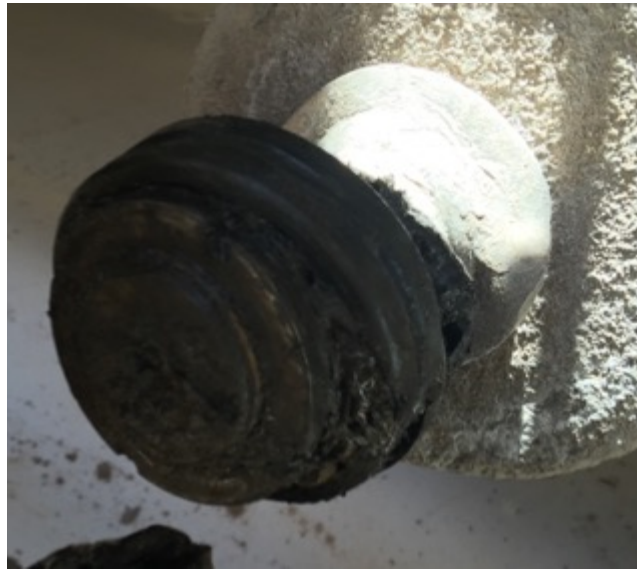
Figura 2.58 Rodamiento lleno de grasa descompuesta.
