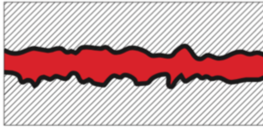
a) Lubricación total Las superficies están separadas totalmente por una película portante de aceite
