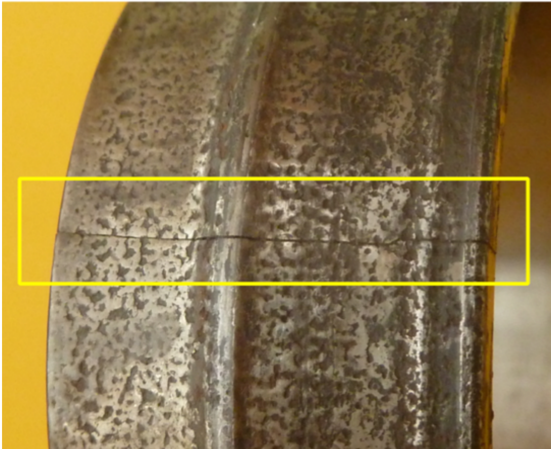
Figura 2.17 Zoom revela fractura en el aro interior.
