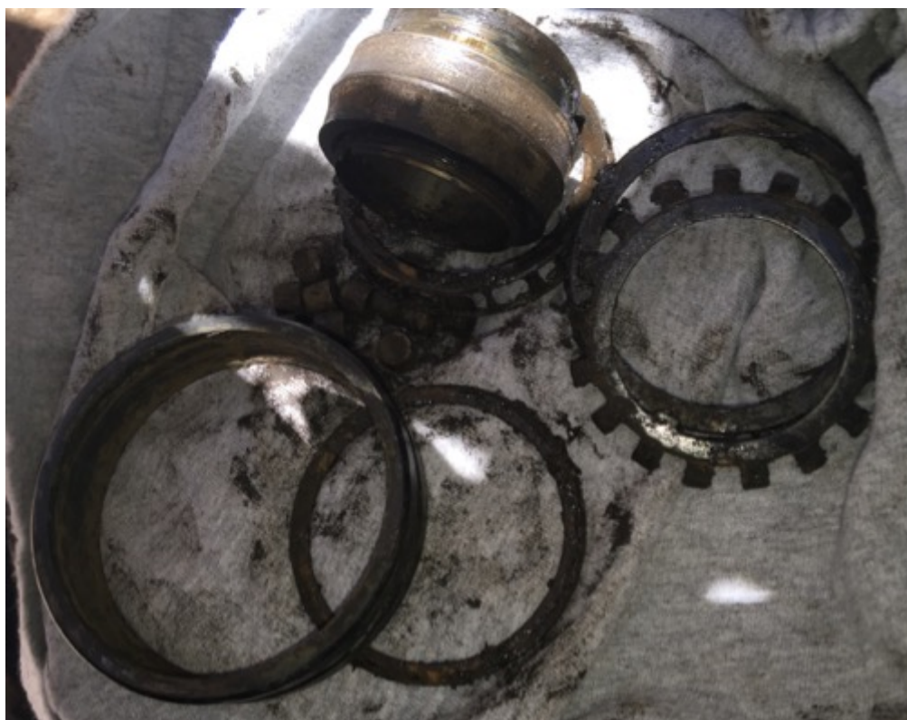
Figura 2.13 Rodamiento completamente desarmado tras su desmontaje.
