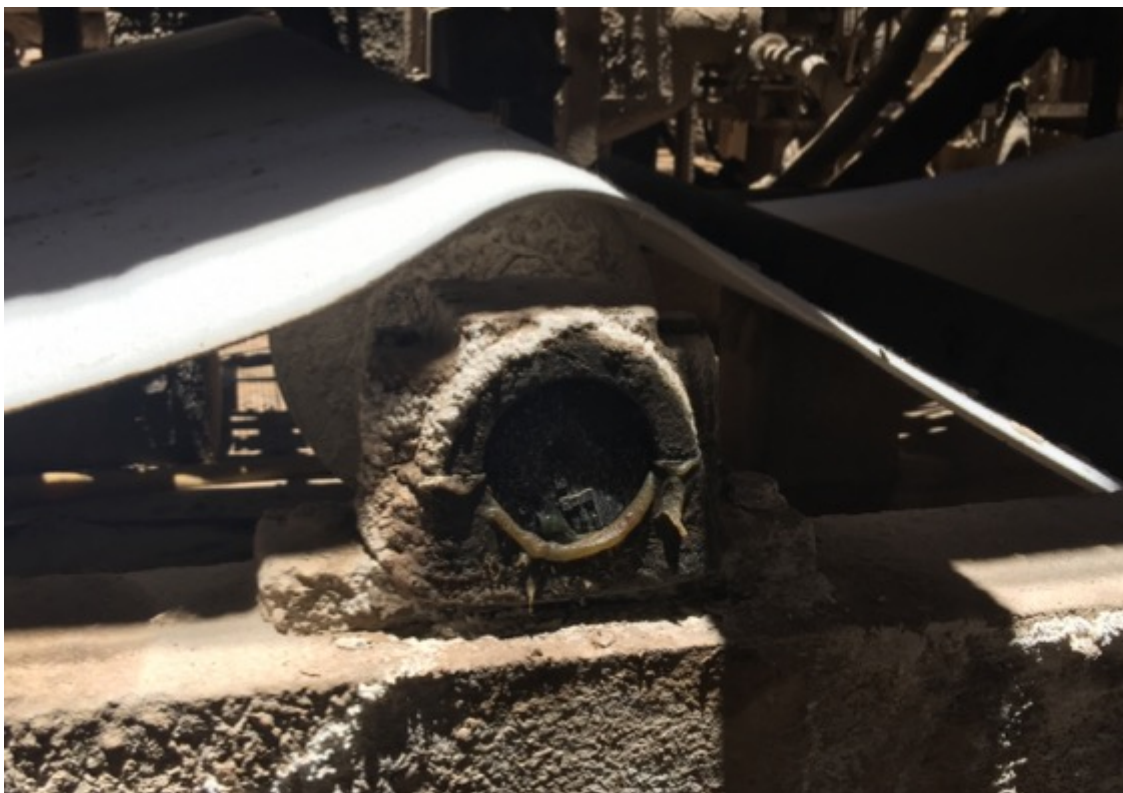
Figura 2.9 Soporte de rodamiento a intervenir, perteneciente al rodillo 11T.
