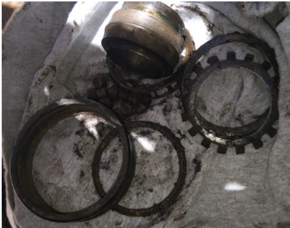
Figura 2.60 Rodamiento completamente desarmado tras desmontaje.
