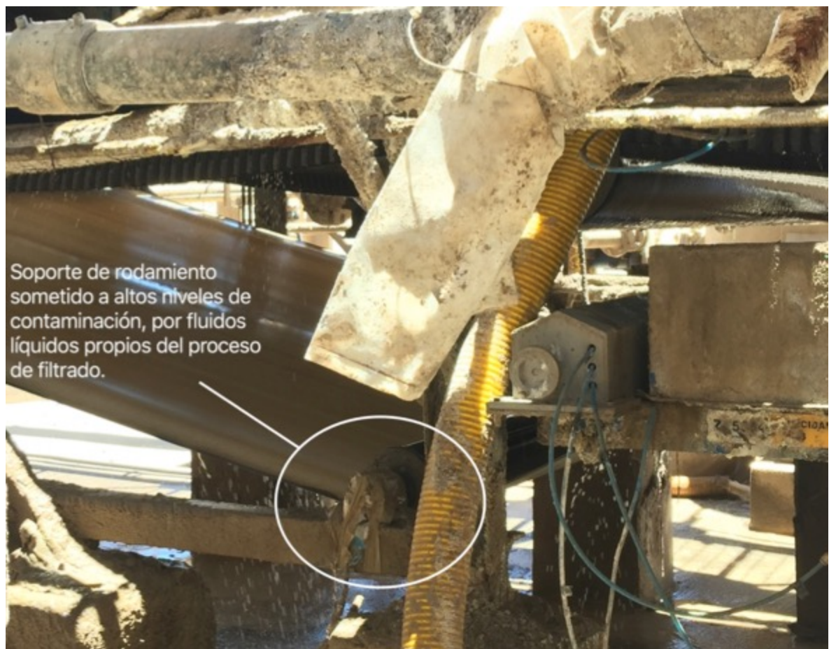
Figura 2.10 Alta contaminación presente en todo el filtro de banda horizontal de vacío.
