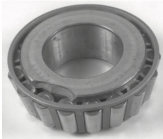
Figura 1.60 Fractura en el hombro del aro interior.
