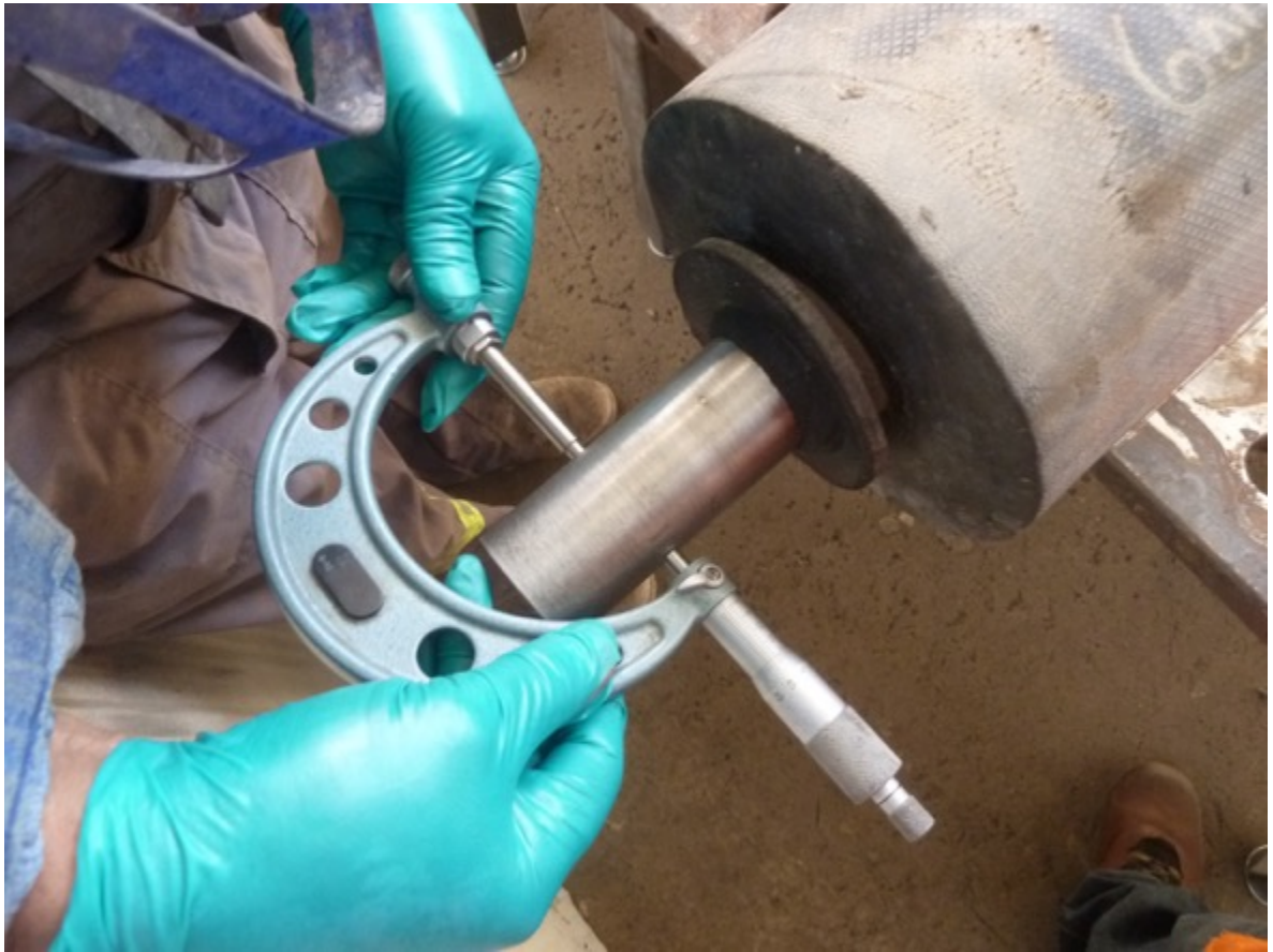
Figura 2.41 Medición del diámetro del eje, mediante un micrómetro de exteriores.
