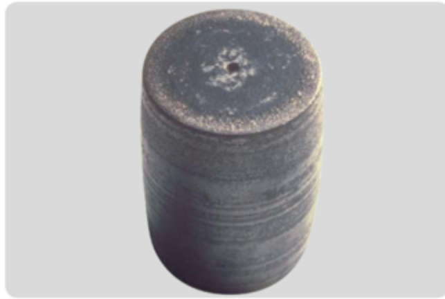
Figura 1.65 Rodillo esférico con daño severo.
