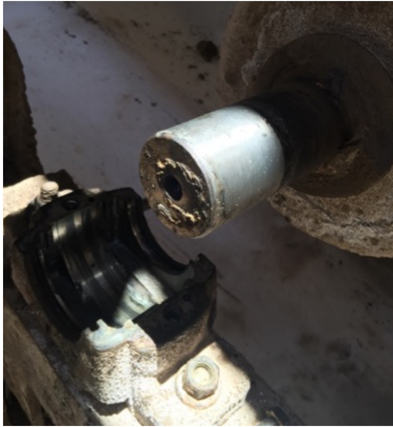
Figura 2.63 Eje libre de impurezas tras ser lijado.
