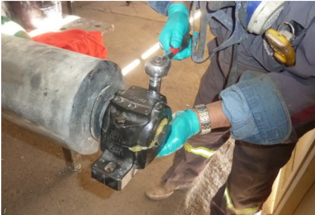
Figura 2.55 Apriete de pernos tapa soporte.
