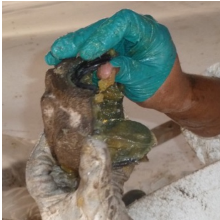
Figura 2.71 Montaje de obturaciones partidas en la tapa del soporte y posterior engrase.
