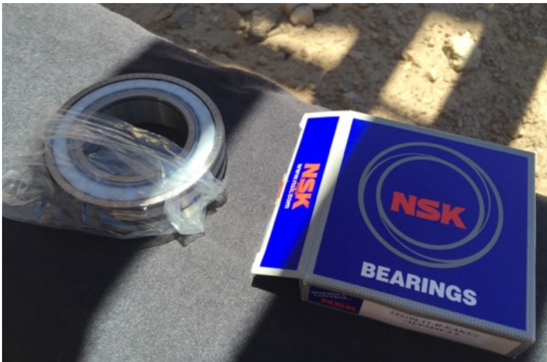
Figura 2.61 Rodamiento nuevo sobre una superficie limpia.
