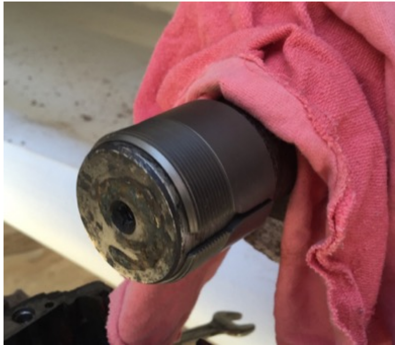
Figura 2.64 Manguito de fijación montado sobre el eje a la distancia correcta.
