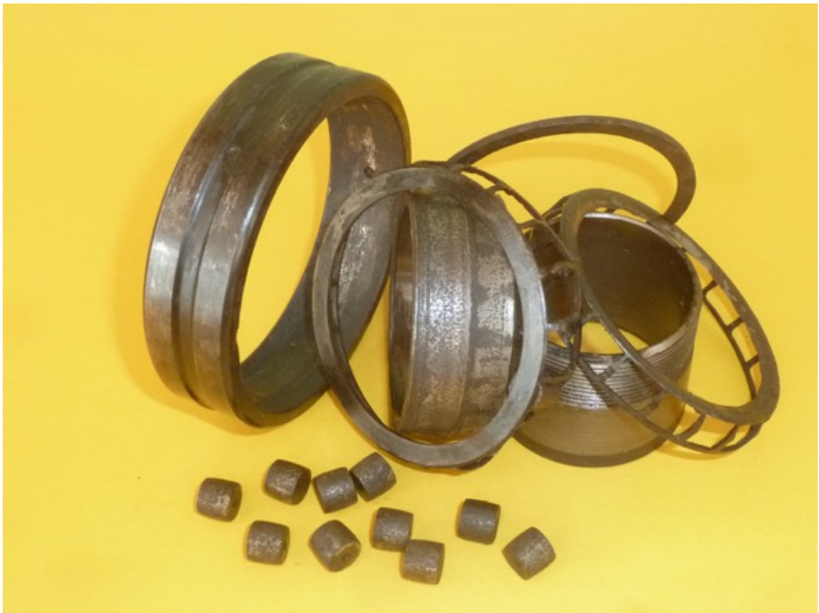
Figura 2.15 Vista general del rodamiento y su manguito limpios.
