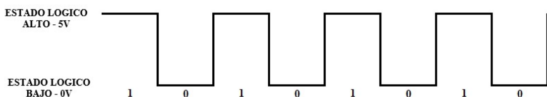
Figura 2-1. Comportamiento de la señal digital.
