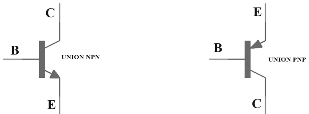
Figura 2-3. Simbología del transistor de unión NPN y PNP.
