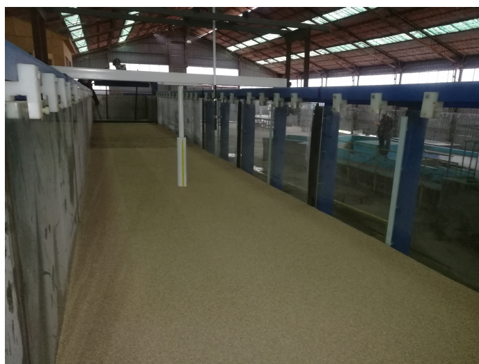
Figura 4.9 Condición final de procedimiento de extensión de sedimento (tipo c).
