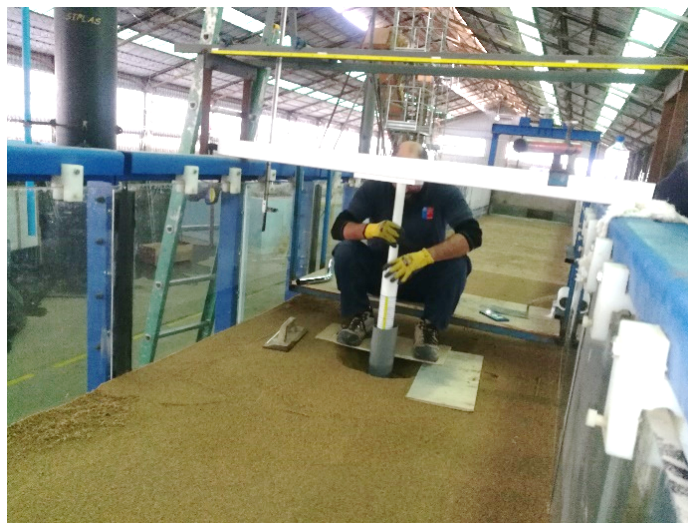
Figura 4.8 Fotografía del posicionamiento de la pila en el canal de socavación.
