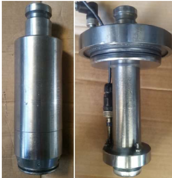
Ilustración 6 y 7 : A la izquierda, dispositivo de clavado cubeta modelos JXQ. A la derecha dispositivo de clavado de los rodamientos superior e inferior modelos JB y L90.
