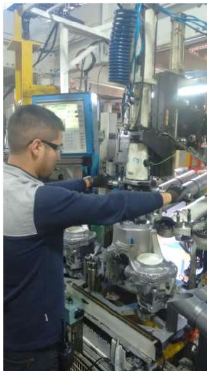
Ilustración 6 Proceso de clavado de piñon fijo de 5ta y desplazable de 5ta REF :RENAULT Cormecánica
