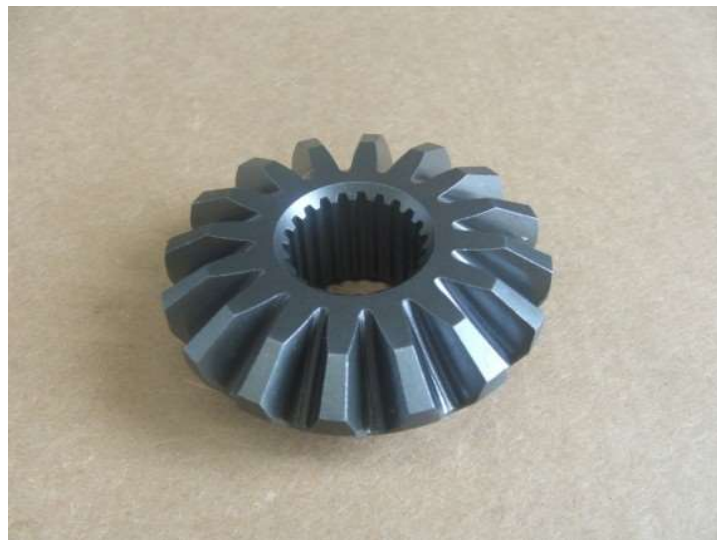
Ilustración 16. Planetario correspondiente a la línea diferencial. Puede apreciarse en su interior el estriado correspondiente que lo une a la transmisión. REF: RENAULT Cormecánica
