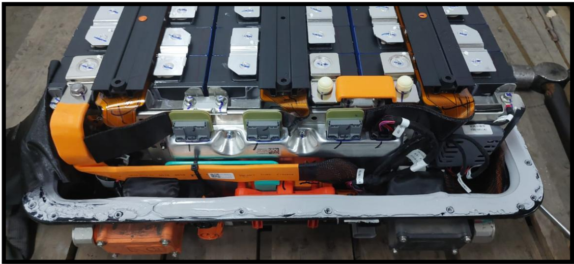
Figura 2-2. Sistema de baterías y refrigeración del bus eléctrico.
