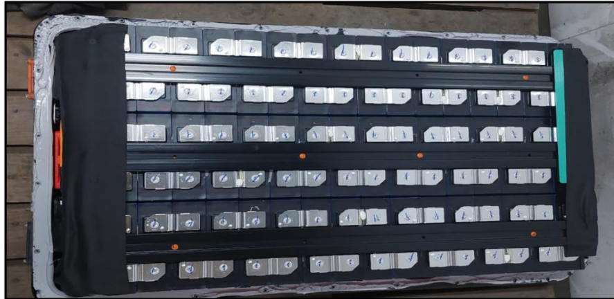
Figura 1-5. Configuración interna de módulos de batería \text{LiFePO}_4 .
