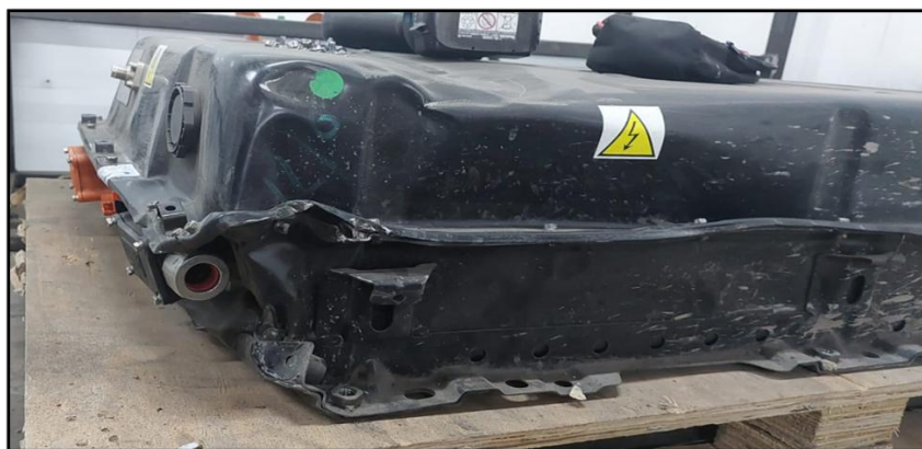
Figura 1-4. Daño estructural en módulo de batería de alta tensión.
