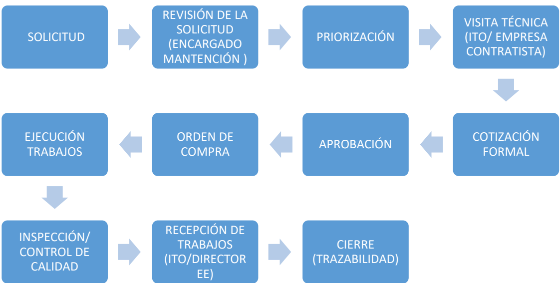
Figura N°8: Propuesta Flujo servicio de mantenimiento
